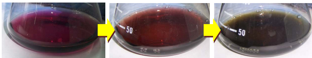
圖(十五)照射 UV 光後，錐形瓶中 \text{Co}^{2+} 酒石酸錯合物逐漸變成 \text{Co}^{3+} 酒石酸錯合物。
