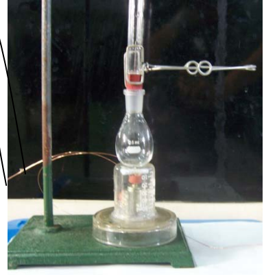
圖(五)反應瓶及自製磁石攪拌器
