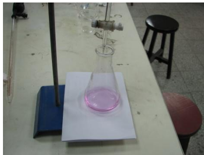
圖 3-2-3 利用酚酞進行酸鹼滴定，滴入氫氧化鈉體積 V(ml)約在 19.9ml。
