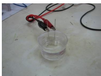
使用自製導電度計及鐵電極測量時情況
