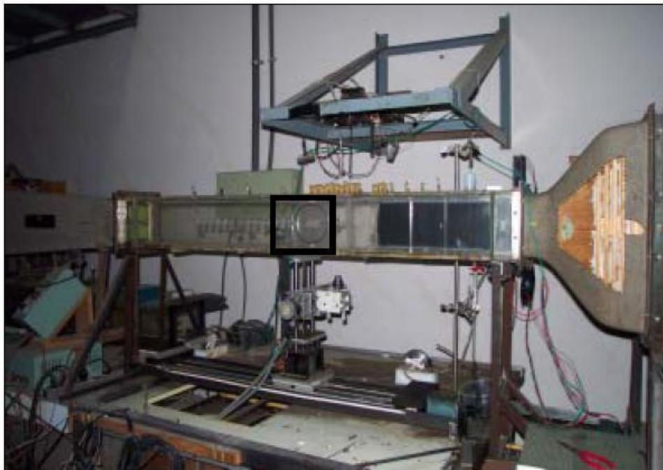
圖 2-2：低速循環式風洞。
