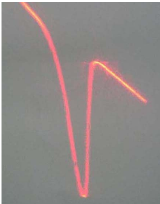
圖一：雷射光經玻璃棒折射成一條和鉛垂線夾角 45^\circ 的斜直線，經過待測液後，因為溶液的折射率隨高度改變，所以在屏上呈現鐘形曲線。
