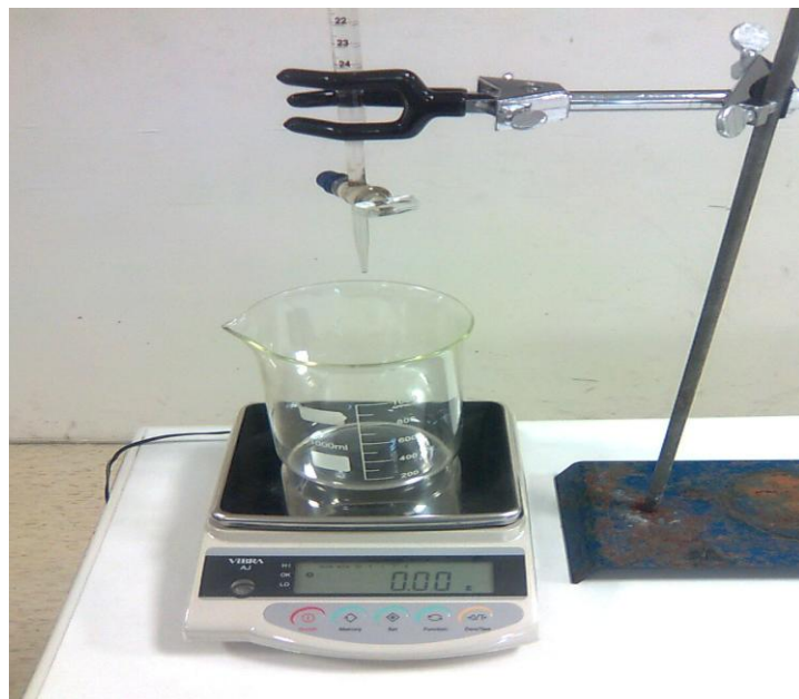
圖 4-3 利用滴定管及電子秤測量液體密度
