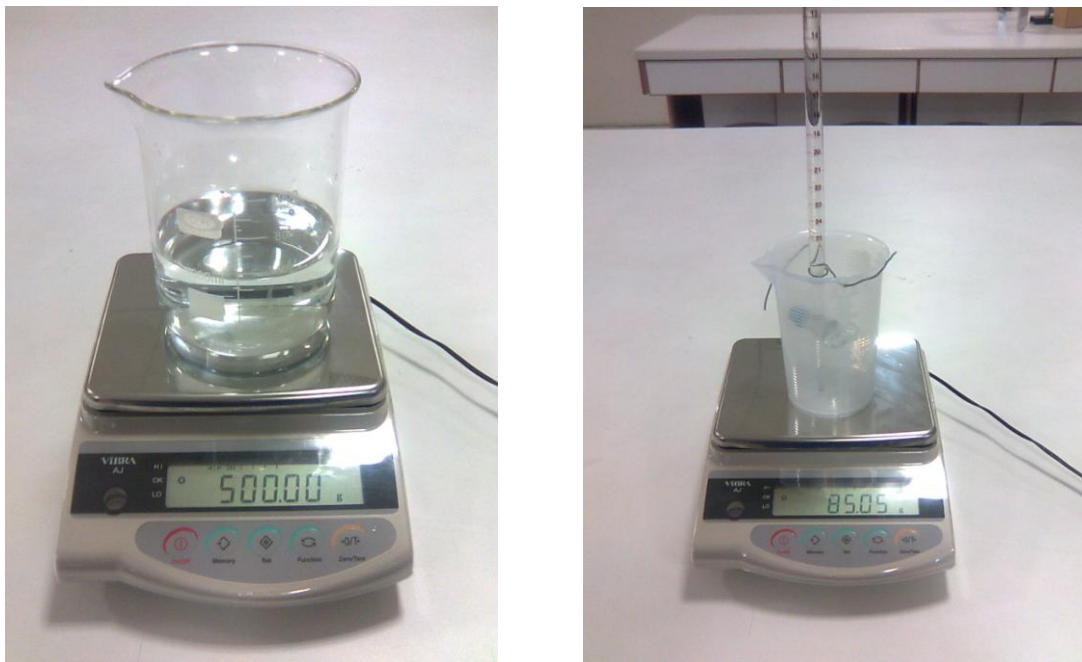
圖 6-3 利用電子秤測量純水蒸發減少的重量
