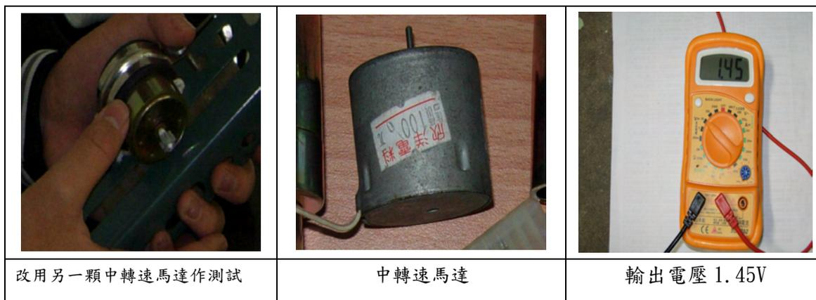
(3)選用另一顆高轉速馬達測試，但自然排風器的扭力、轉速都不夠大，馬達不易旋轉，發電機輸出的電壓反而更少。
