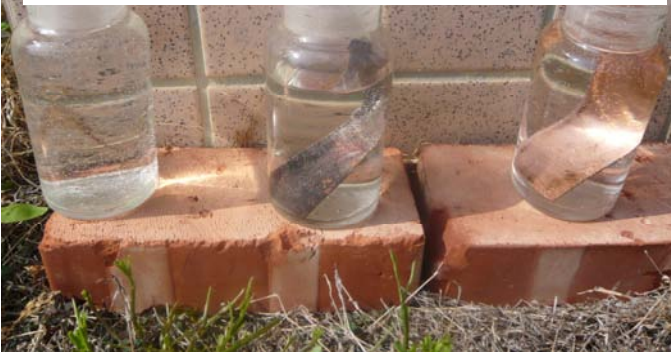
圖八 比較廣口瓶中放水、廣口瓶中放銅片、廣口瓶中放用砂紙刮過的銅片的效率實體圖
