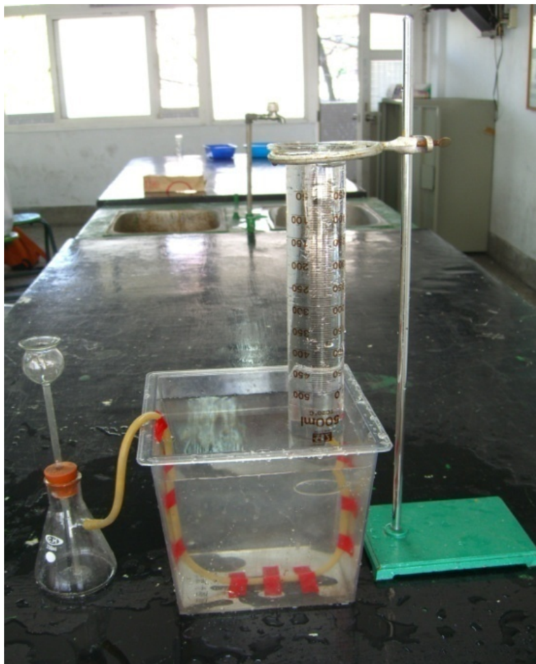
圖 5-1-2 量筒排水集氣法
