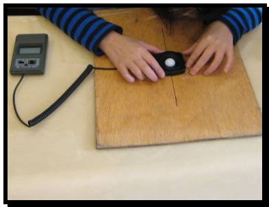
圖 16 將照度計固定在木板上，對準中心線。
