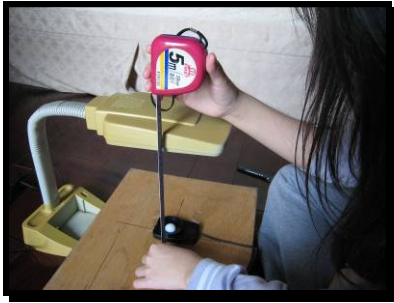
圖 40 固定燈管到照度計的距離
