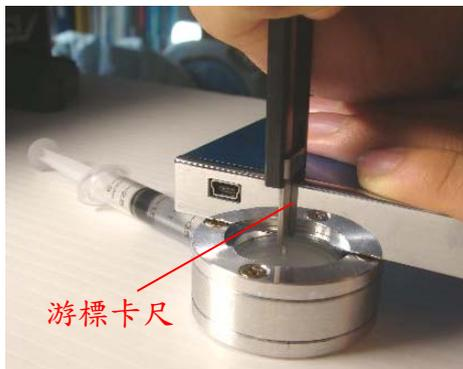
圖 9.4 薄膜外擴距離的量測方法
