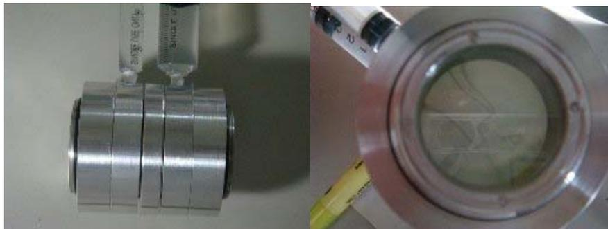
圖 7.5 完成之第三代液體透鏡模組和可變焦距鏡片系統
