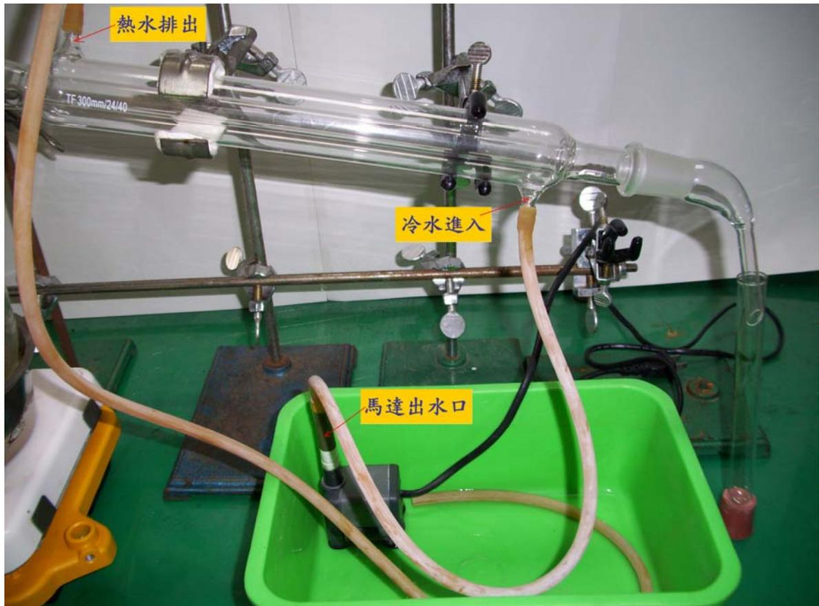
圖 6-4-1 抽水馬達和塑膠水盆來裝置循環冷卻水
