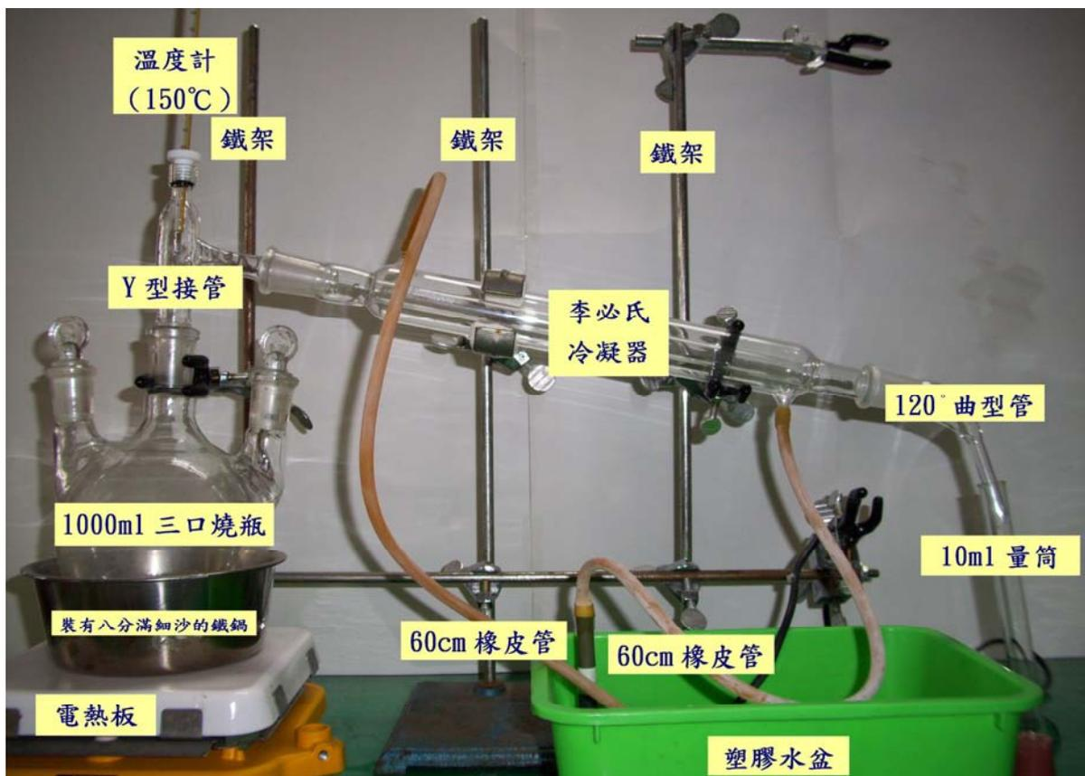
圖 3-1-1 實驗室制式精油蒸餾器材
