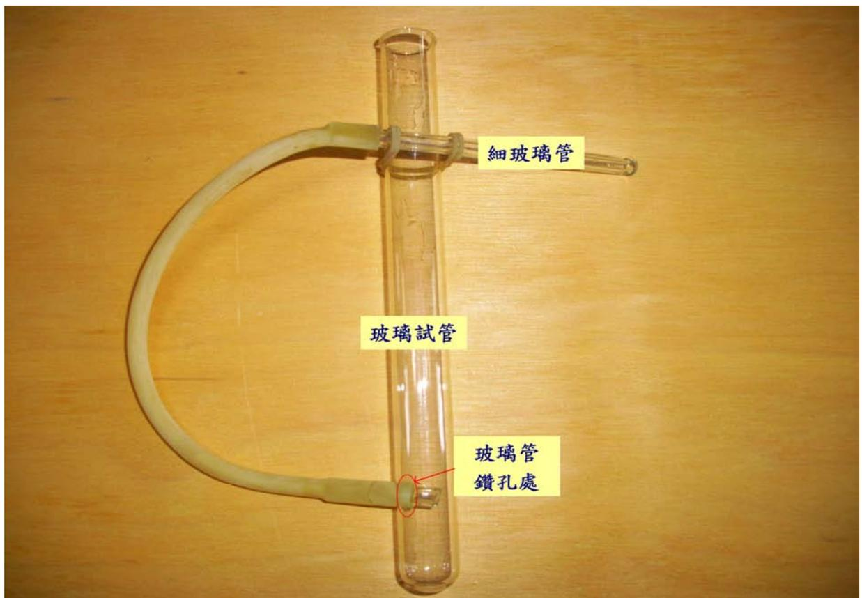
圖 3-1-3 自製精油分流的實驗器材
