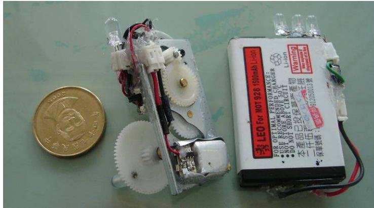
圖 25 我們最小的手搖充電手電筒 (中)，大小和一個鋰電池大小差不多
