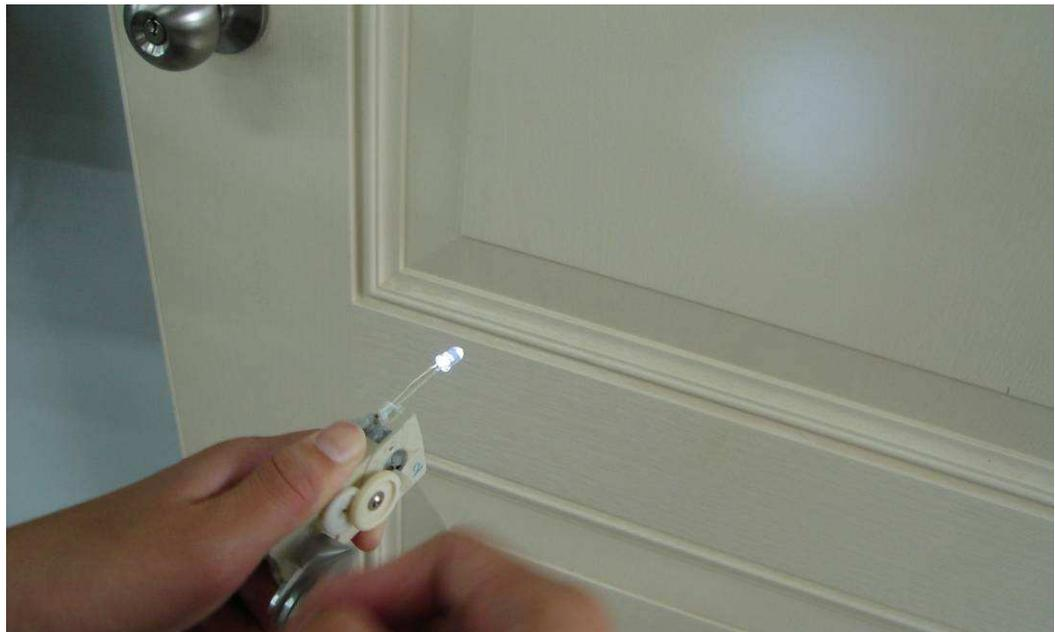
圖 10 功率較大的[手搖發電機 2]可使白 LED 燈發光
