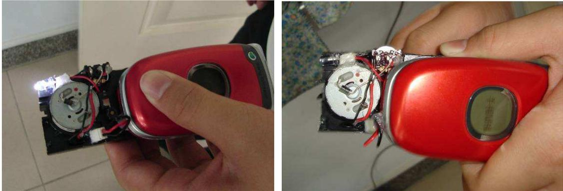
圖 27 以手機取代充電電池，充電時還可顯示「手機關機充電中」。
