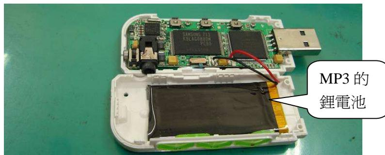
圖 26 我們拆開 MP3 研究其充電鋰電池，體積小，是適合我們作品的充電電池。
