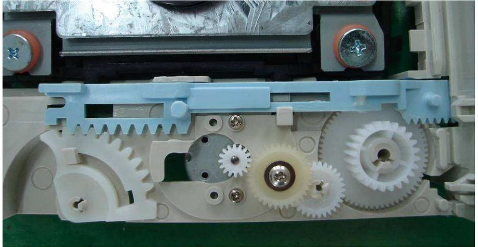
圖 2 光碟機內的直流馬達與傳動齒輪組
