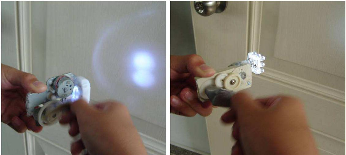
圖 20 我們的手搖發電手電筒，分別裝置 3 個和 9 個 LED 燈
