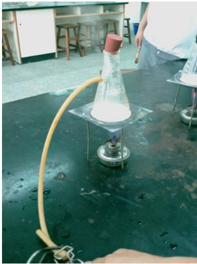
圖九 夾住試管使橡皮塞被彈開以確定錐形瓶內已充滿水蒸氣
