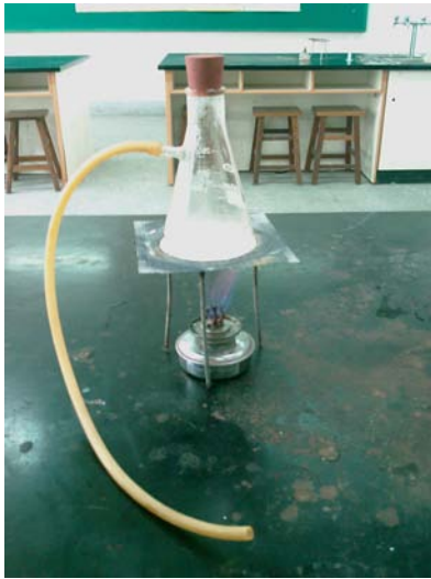
圖八 在錐形瓶上放置橡皮塞使水蒸氣能從橡皮管內排出以擠出空氣
