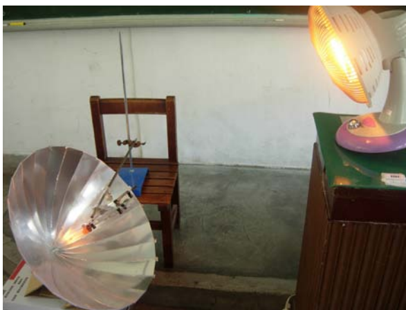
圖 11 套上透明試管的焦點溫度測試
