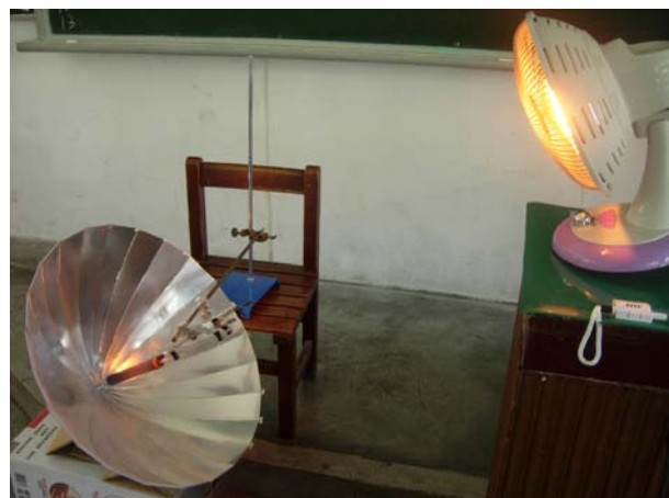
圖 12 套上黑色試管的焦點溫度測試
