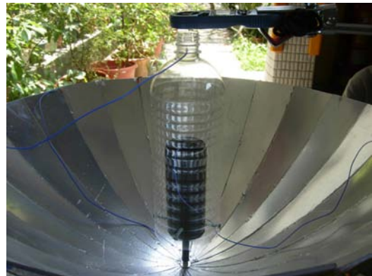
圖 25 爐心加熱空氣產生熱對流擺設位置
