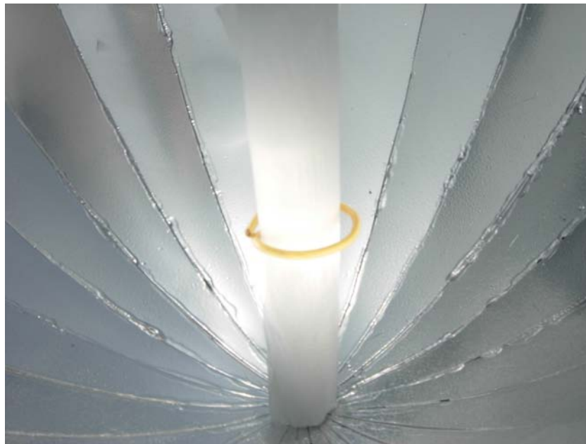
圖 41 陽光在紙軸上聚焦的情形
