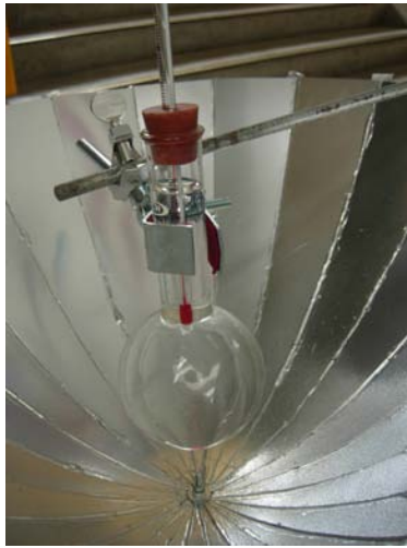
圖 23 太陽爐功率測試裝置圖
