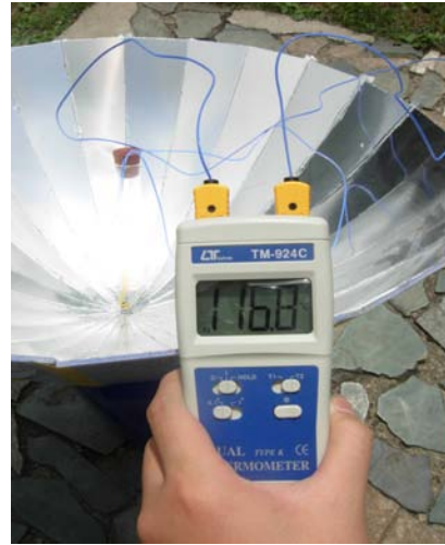
圖 20 管外焦點附近的溫度
