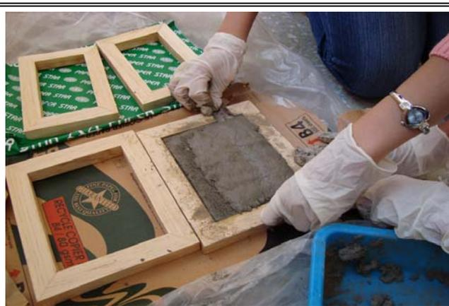
利用水泥土和泥沙混合酌量清水，放入訂製木盒中，自製實驗用水泥土塊。
