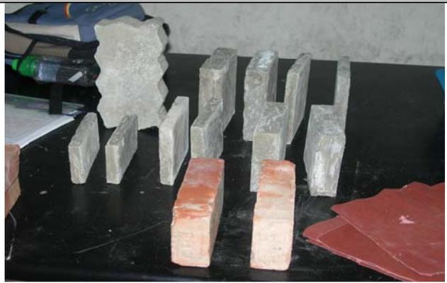
在校園中找來的磚塊和造型磚(有跟警衛伯伯報告)，以及晾乾五天的自治水泥磚塊。
