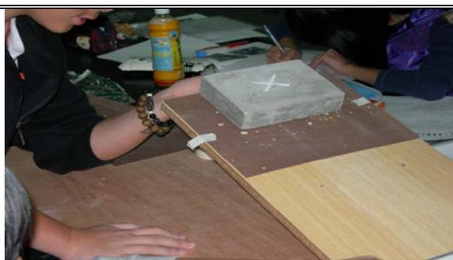
利用碎餅乾(蘇打餅)壓在接觸面之間，模擬碎屑岩上方岩層的下滑情形
