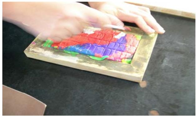
黏土塊邊坡下滑實驗，記錄下滑瞬間的角度。接觸面進行十字形刮痕後，下滑角度變大。
