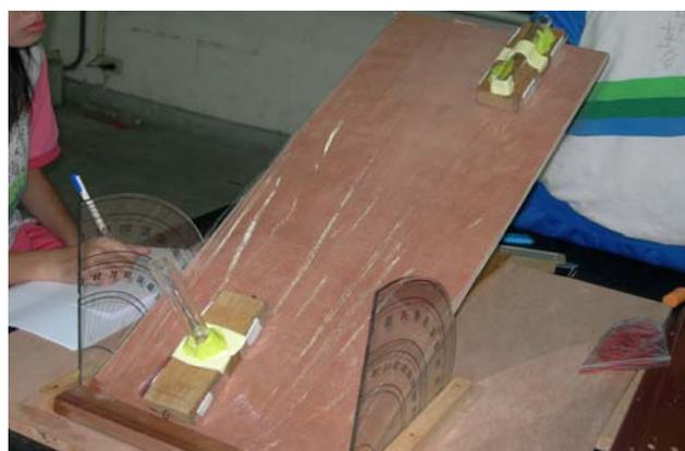
利用木塊及壓克力空管，拼出兩塊重量相同和接觸面相同的木塊。
