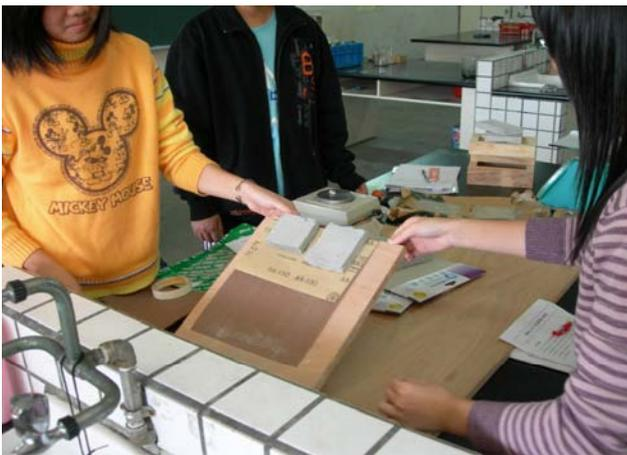
觀察岩塊在不同粗細砂紙介面的下滑情形
