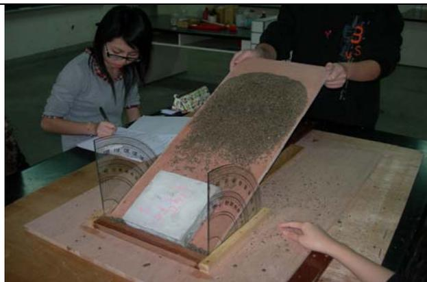
到各地及河川選取所需的礫石、砂石、泥土、腐植土等樣品，進行邊坡土石下滑實驗。
