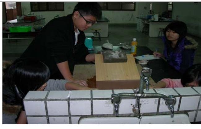
同一種砂紙，用少量水和多量水，比較下滑情形。再改用光滑面加上清水，岩層下滑情形。
