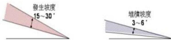
土石堆積及滑動坡動示意圖
