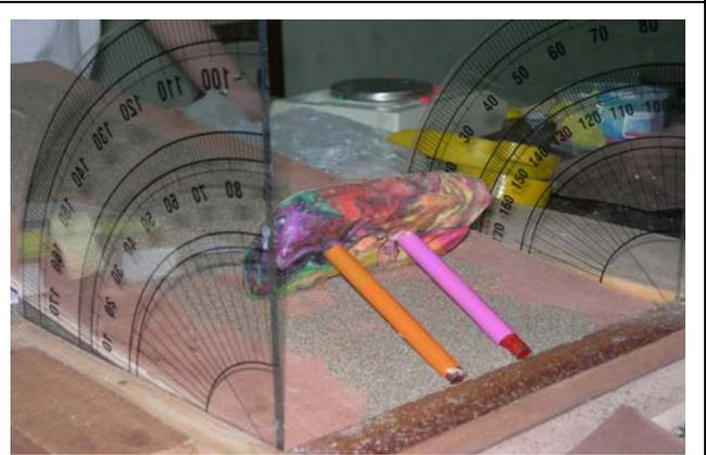
利用黏土塊插上兩根鐵塊(重量非控制變因)，改變接觸介面的介質種類，觀察下滑情形。
