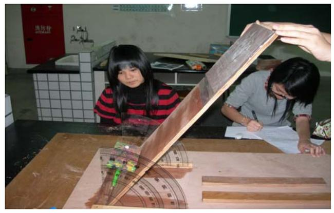
插上三支管子(分為空心管和放入鐵棒管)，插鐵棒管的岩塊下滑角度大幅下降。
