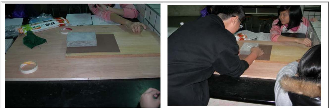
將水泥塊『有磨平』的接觸面和『未磨平』的接觸面，在砂紙面上做下滑實驗。
