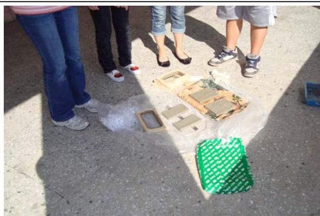
自製實驗水泥土塊成形後，讓他們曝曬及晾乾數日，變成為我們的實驗器材之一。
