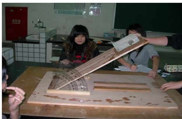
岩塊在腐植土及濕土界面上，觀察其因坡度改變的下滑狀況實驗操作圖。
