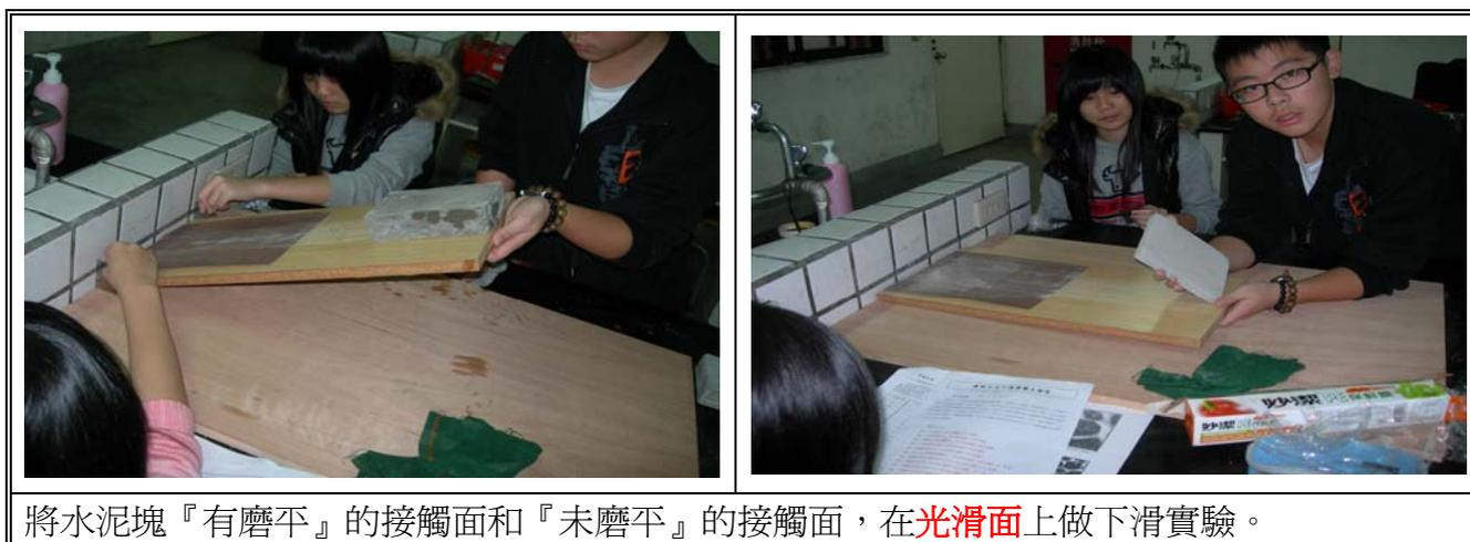
將水泥塊『有磨平』的接觸面和『未磨平』的接觸面，在光滑面上做下滑實驗。
