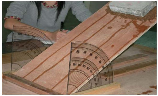
磚塊以各種方式平面擺放時，下滑角度差不多，但垂直擺放時，非常容易下滑。
