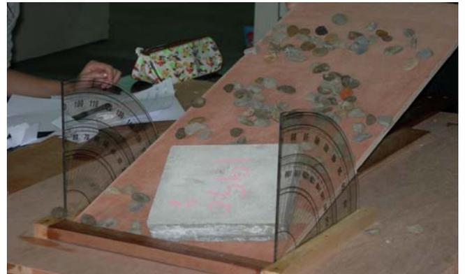
很多在岩層與坡面的接觸面間放置鬆散岩石碎屑的實驗發現，岩層較容易下滑。
