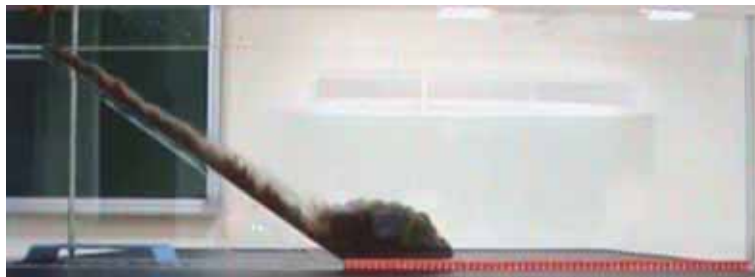
圖 13-4 泥水在斜坡底部累積，再沿平面向右前進。
