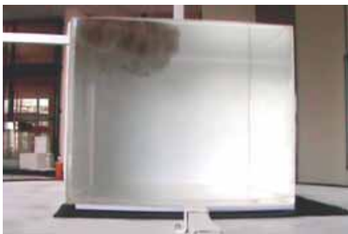
圖 10-7 泥水持續排入水槽，浮在上層的泥水越積越多。
