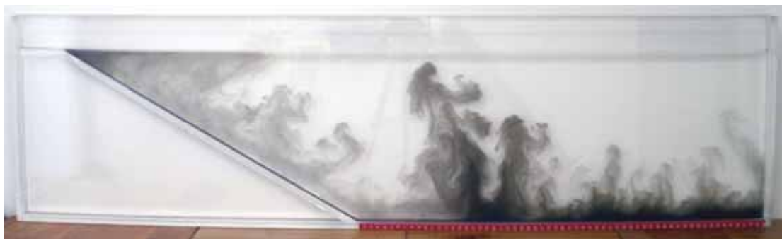
圖 18 槽底泥水向上擴散之情形
