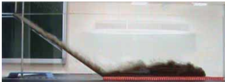
圖 13-6 隨著泥水前端向右，其後方泥水、鹽水交界面上亦發生波動現象。
