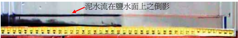
圖 9c-2 t=7 秒時，泥水和鹽水交界面有波動現象。
