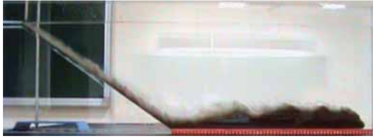
圖 13-7 t=16.0 秒時，泥水前端即將抵達水槽右邊界。
