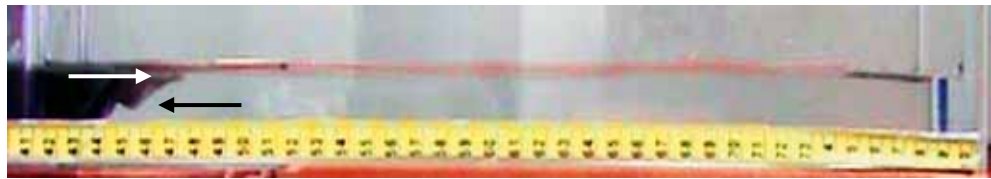
圖 9a-1 隔板抽出後，t=2 秒時，泥水向右前進並與鹽水於交接處形成泥水在上鹽水在下的斜面。
