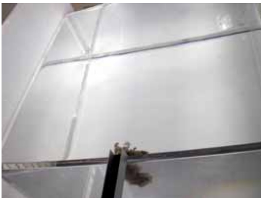
圖 10-1 泥水一開始進入鹽水中瞬間向下擴散。
