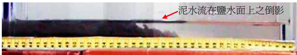
圖 9b-3 t=17 秒時，泥水已達皮尺刻度 64 cm 處，前端泥水有向上漂浮之現象。
