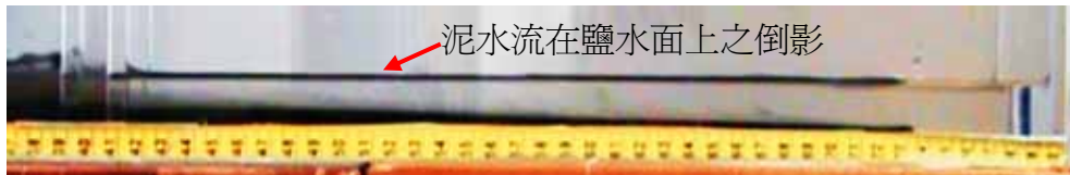
圖 9d-3 t=10 秒時，泥水接近水槽右端終點，前面曾出現近似捲雲的波動，似乎已消失。
