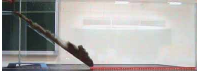
圖 13-3 t=7.0 秒時，泥水前緣已達斜坡底部，前緣部份轉動之後，泥水與鹽水交界面上尚有波動現象發生。
