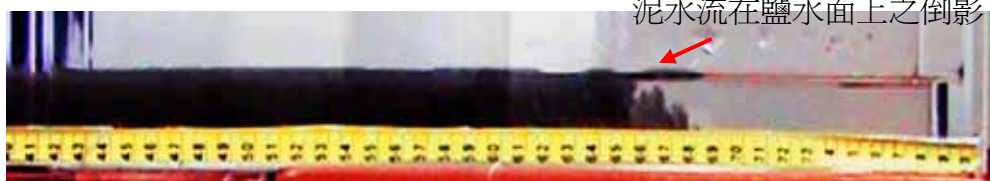
圖 9b-4 t=25 秒時，泥水前端向上漂浮之現象更為顯著，泥水、鹽水交界之斜面消失。
