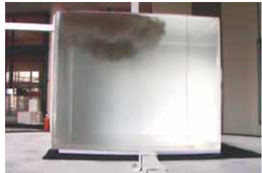
圖 10-8 t=4 秒時，浮在上層的泥水體積增大。
