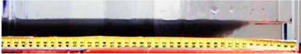
圖 9b-6 泥水與鹽水間形成和濃度 40g/kg 時相似的傾斜界面。
