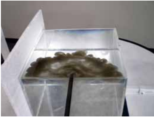
圖 10-3 t=3 秒時，泥水在表面擴散成扇形，其邊緣呈波浪狀。
