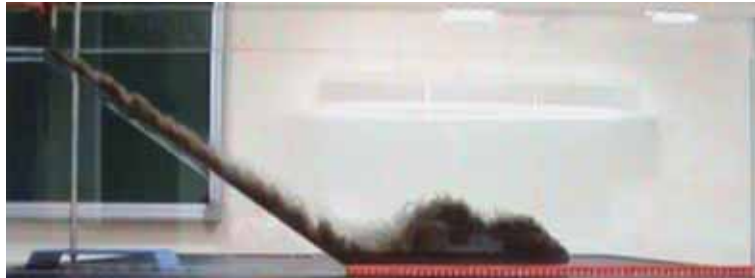
圖 13-5 泥水前端部分體積增大，並且一分為二成爲兩股，斜坡上的泥水與鹽水交界面上仍有波動現象。
