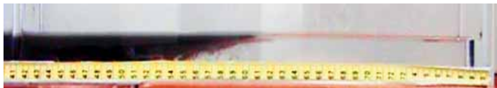
圖 9a-2 t=16 秒，泥水持續向右挺進，泥水與鹽水交界面更加傾斜。
