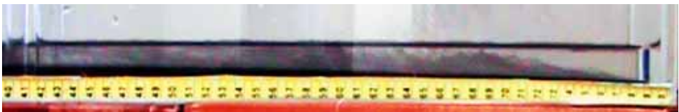
圖 9c-3 t=16 秒時，泥水抵達水槽右端終點，此時泥水與鹽水部分混合，交界面逐漸消失。
