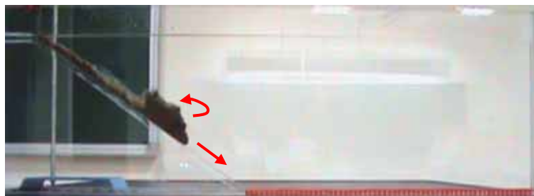
圖 13-2 泥水下滑過程中，前緣後方發生反捲現象，並如轉子一般在下滑過程中沿斜坡不斷旋轉。
