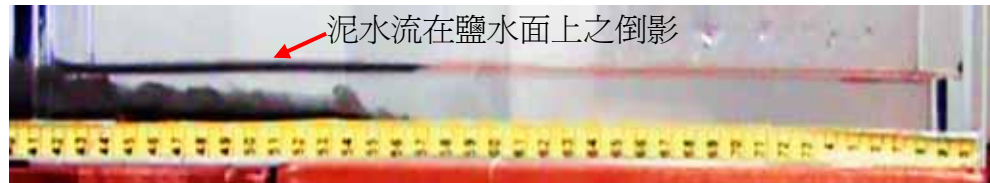
圖 9b-2 t=9 秒時，泥水持續由底層向右，泥水和鹽水間有波動產生。
