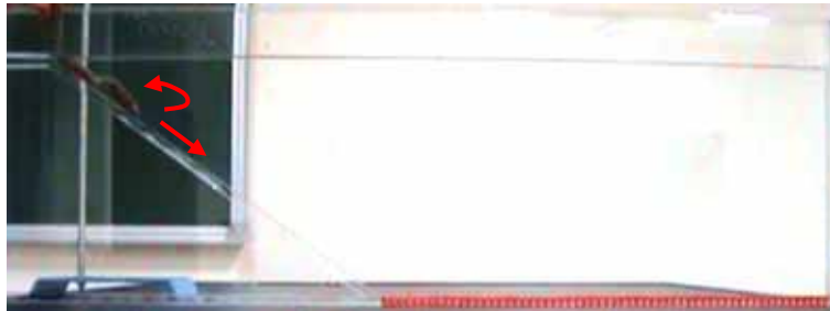
圖 13-1 高密度泥水進入底床斜坡下滑時，前端較厚，其後較薄。
