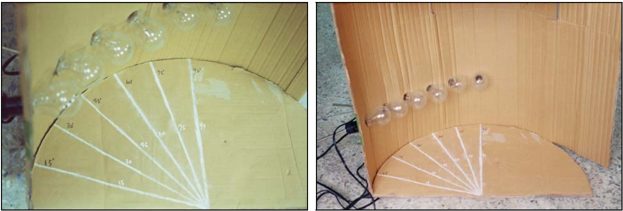
圖五 箱子內側標示著 15^\circ ~ 90^\circ 每 15^\circ 爲一個間隔，且各角度固定了一個燈泡。
