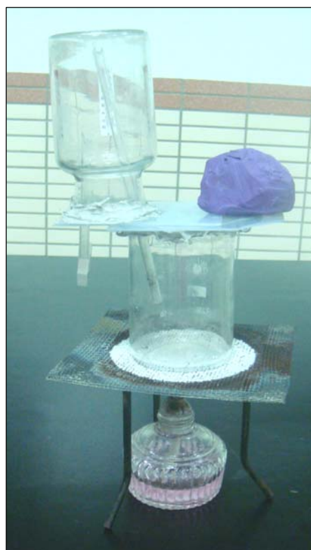
圖八 將廣口瓶倒放至燒杯上。長玻璃管連通整個裝置是爲了讓水蒸氣進入廣口瓶內，短玻璃管能使廣口瓶中的其他氣體排出。將整個裝置擺到陶瓷纖維網上，燒杯內裝水燃燒。等待短玻璃管上的氯化亞鈷試紙變色後，即開始實驗。
