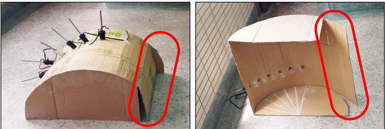
圖六 箱子外觀。紅線圈起是一個可活動的門，目的是爲了噴水及放入溫度計之方便。
