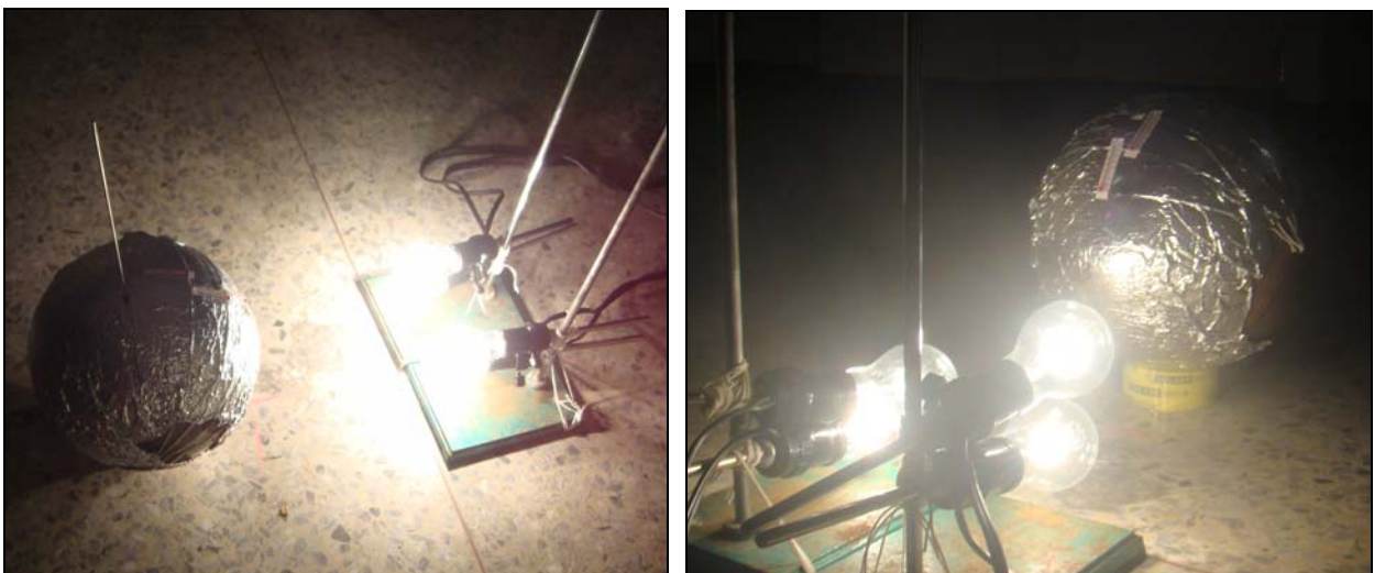
圖十 用四個 60 瓦燈泡模擬太陽的平行光。在籃球中心插入鐵棒作為地軸。鋁箔紙凹凸部分為籃球表面貼有的棉線所形成。光源是對準赤道在地軸偏向角為 0^{\circ} 的情形下之位置。
