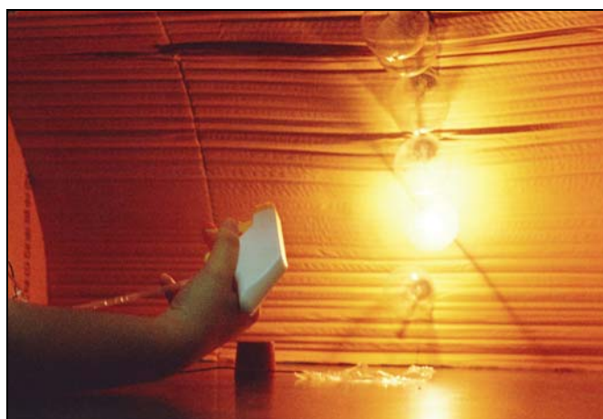
圖十四 朝實驗箱頂噴水。保鮮膜是爲了不讓溫度計受小水滴干擾而影響了結果。
