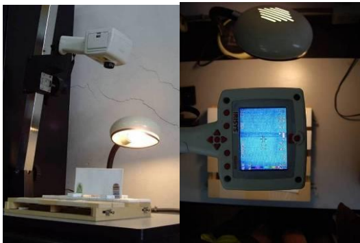
照片（十五）紅外線影像溫度儀器架於蝴蝶正上方，檯燈置於翻拍架旁
