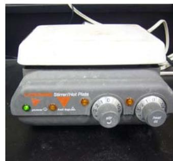
圖 23、電磁加熱攪拌器
