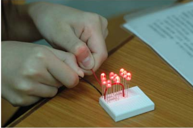
圖十：測試及組裝 LED 燈
