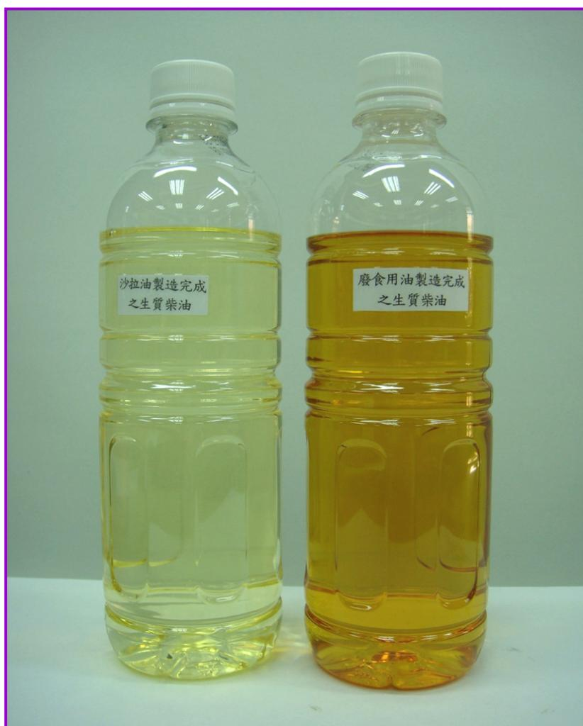
圖二十九 以沙拉油及廢食用油製造完成之「優質生質柴油」
