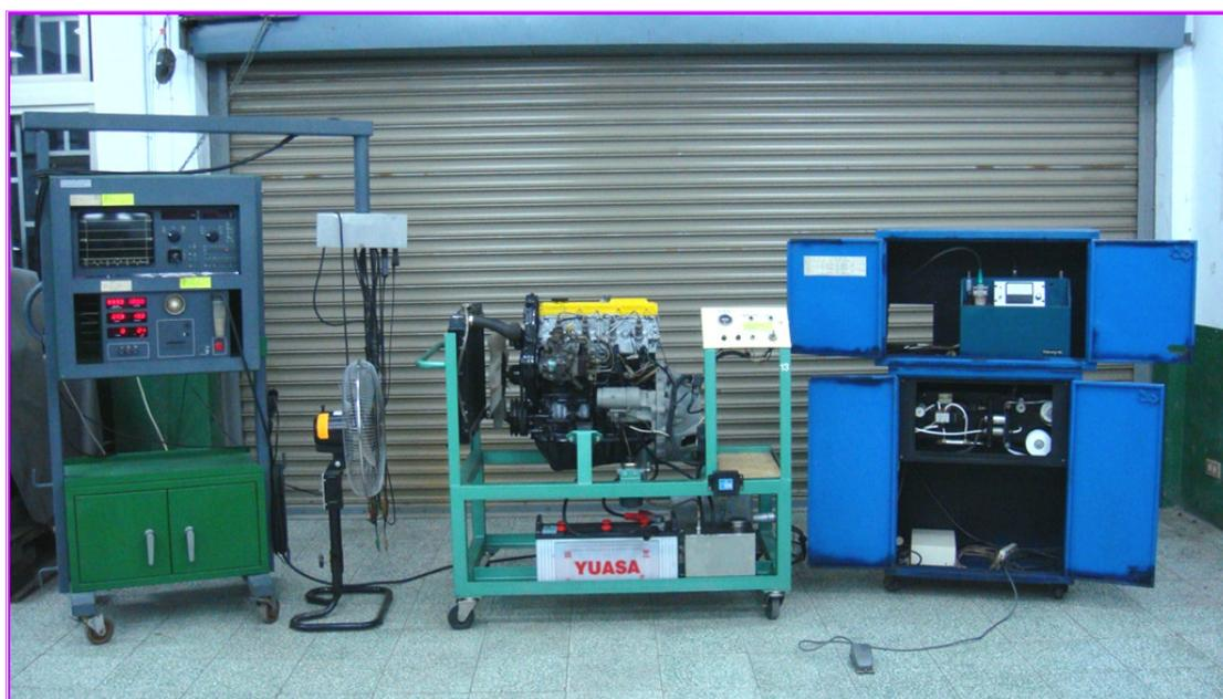
圖三十一 進行柴油引擎廢氣排放檢測（由左至右分別為 Four-gas 廢氣分析儀、柴油引擎及 碳微粒污染度分析儀）
