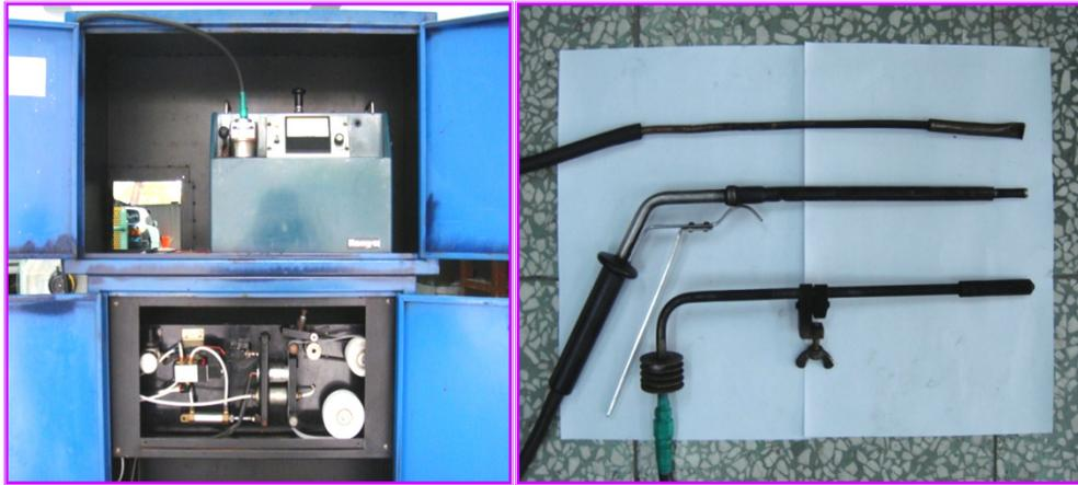
圖三 碳微粒污染度分析儀及廢氣取樣管（上：NO<sub>x</sub> 取樣管；中：Four-gas（HC、CO、O<sub>2</sub> 及 CO<sub>2</sub>）取樣管；下：碳微粒污染度取樣管）
