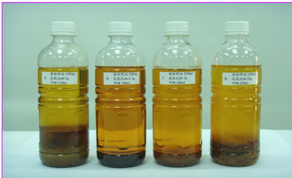
圖三十三 廢食用油、甲醇及氫氧化鈉於不同配方比例下所製造出之生質柴油
