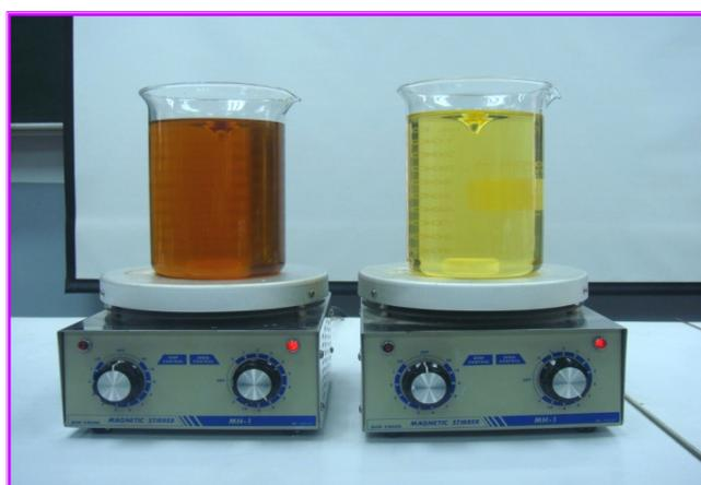
圖二十四 將滴入冰醋酸的生質柴油溶液放到加熱攪拌機上予以攪拌進行中和反應
