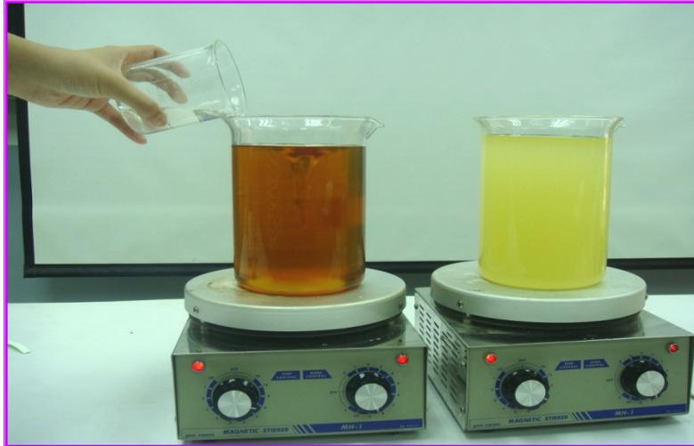
圖二十六 將 50ml 的飽和食鹽水溶液分別倒入廢食用油及沙拉油製造的生質柴油半成品中進行加熱攪拌水洗
