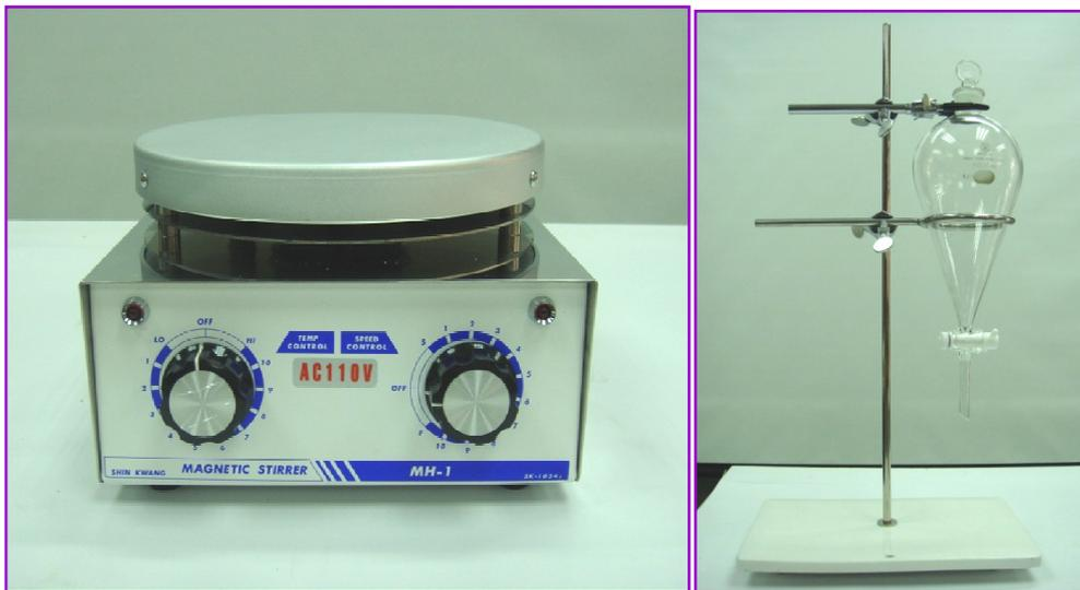
圖四 加熱攪拌器、分液漏斗及分液漏斗架
