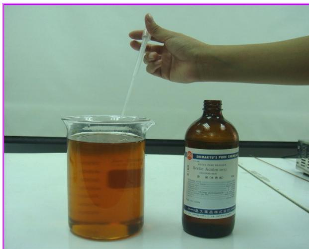
圖二十三 將冰醋酸滴入廢食用油製成的生質柴油中準備進行中和處理
