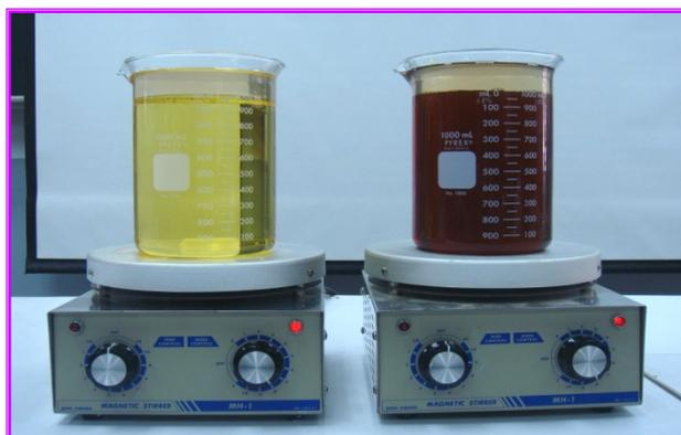
圖十一 將攪拌完成的甲醇鈉溶液到入沙拉油及廢食用油中
