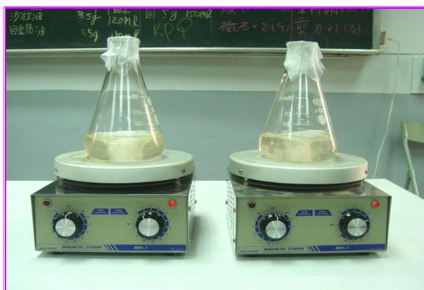
圖十 氫氧化鈉及甲醇利用加熱攪拌器進行攪拌使成為甲醇鈉溶液
