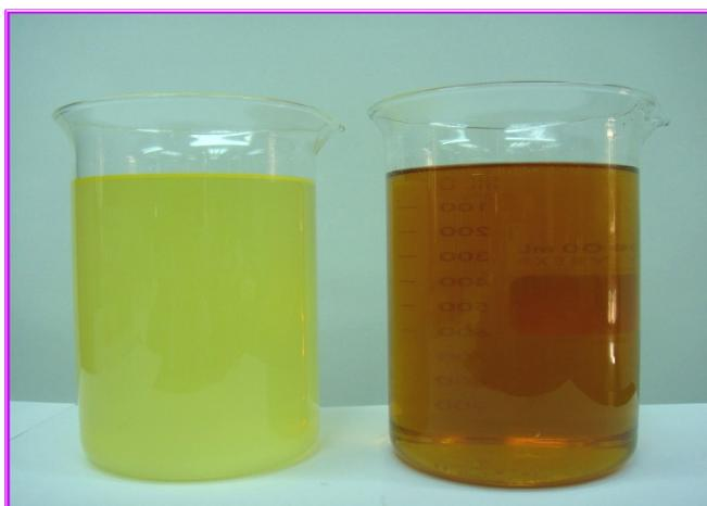
圖二十八 油水分液後尚未進行蒸餾以去除水分之生質柴油
