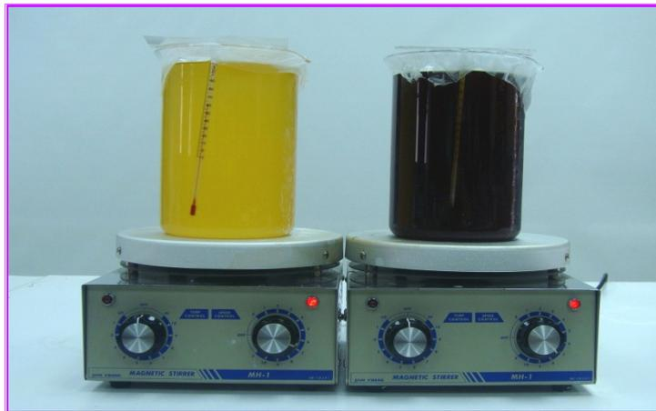
圖十三 將沙拉油及廢食用油分別與甲醇鈉溶液加熱攪拌進行轉脂化反應
