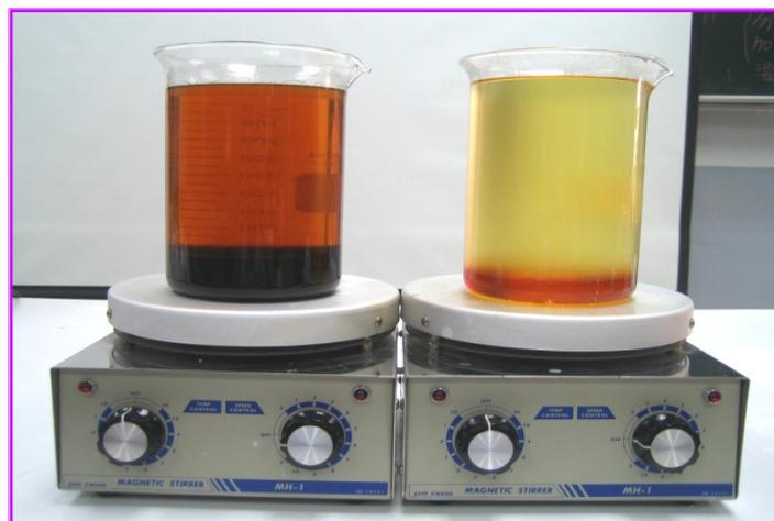
圖十四 經加熱攪拌完成轉脂化的沙拉油及廢食用油溶液
