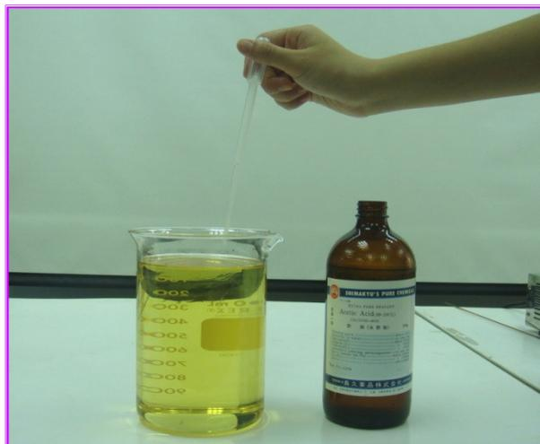
圖二十二 將冰醋酸滴入沙拉油製成的生質柴油中準備進行中和處理
