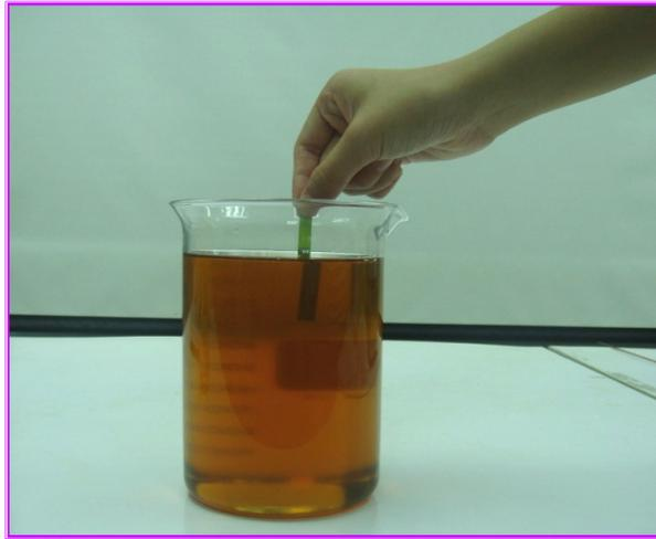
圖二十 將萬用試紙放入廢食用油製造的生質柴油中以檢測其 pH 值
