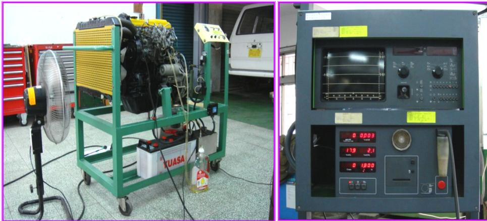
圖一 福特載卡多柴油引擎及 BOSCH Four-gas 廢氣分析儀
