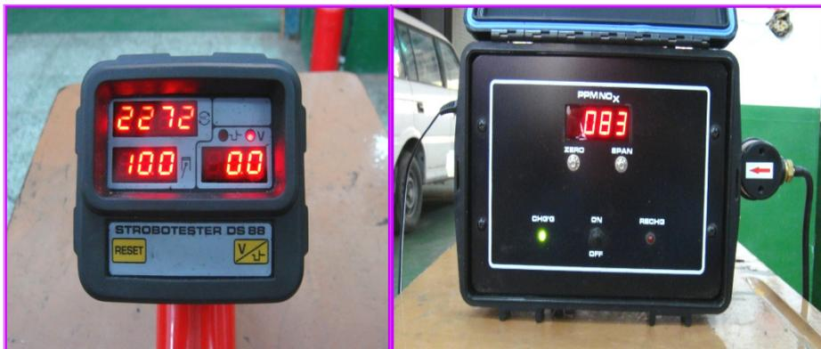
圖二 柴油引擎正時轉速錶及 NO<sub>x</sub> 廢氣分析儀
