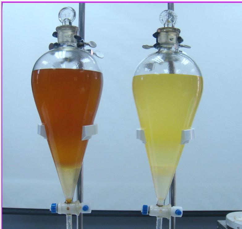
圖二十七 將水洗完成的生質柴油倒入分液漏斗中
