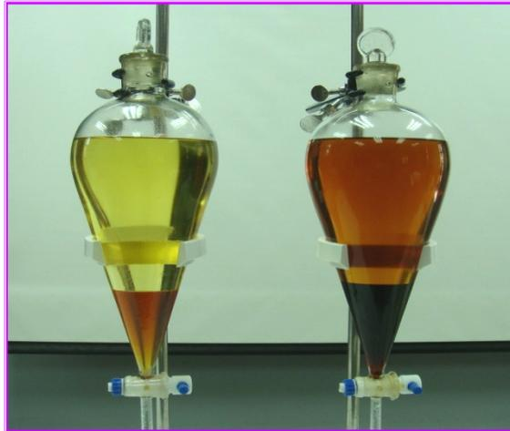
圖十五 將進行轉酯化反應後之沙拉油及廢食用油溶液倒入分液漏斗內
