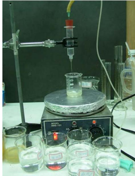
磁石攪拌機上攪拌膠液，滴定不同濃度酒精
