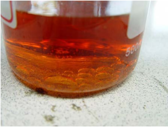
照片 2：醋酸和自來水加入量太少時，底部會形成氣泡易產生突沸
