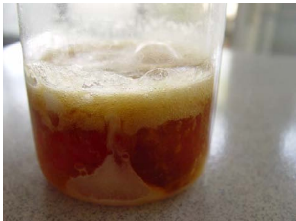
照片 6：碳酸氫鈉+醋酸產生大量氣泡，並浮出塊狀物
