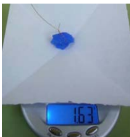
▲圖 [12] 在 900Hz 之下，結晶重量為 1.63 克，增加 0.77
