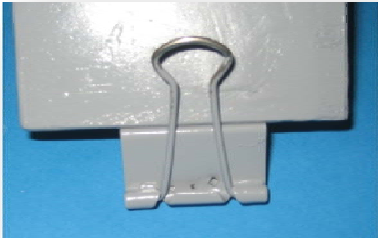
圖 56 布料夾打洞圖 經由這樣處理，可使布料夾更加夾緊布料。
