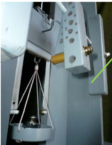
圖 27-3 砝碼懸掛裝置及雷射光源。
