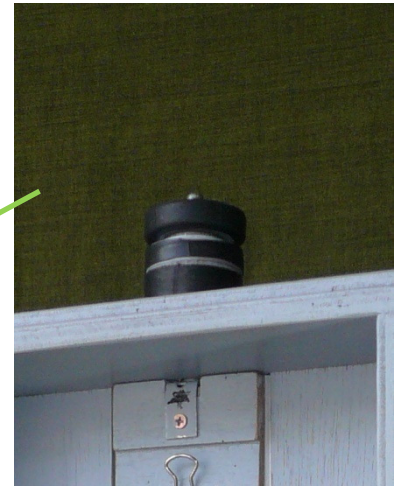
圖 27-4 微調裝置，藉由旋緊此一裝置來微調布料高低，來控制雷射光位於初始零點。
