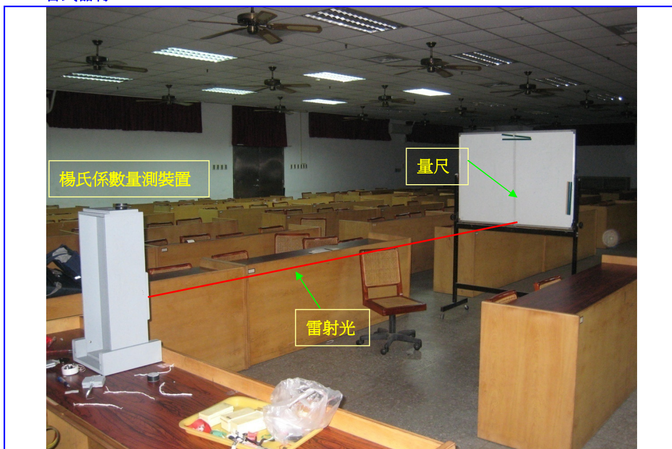
圖 1 自製楊氏係數量測系統
