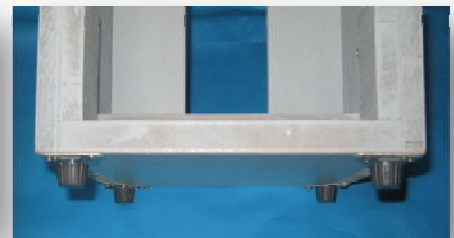
圖 58 水平微調裝置 當系統不式在水平狀態時，可用此裝置維維調。
