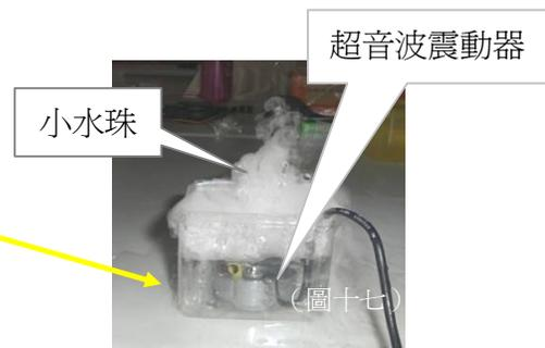
水霧的量很符合需求，但是煙霧的卻無法上升太高，所以我們決定在旁邊放上一個電腦用的散熱風扇改變壓力，將小水滴擠出寶特瓶，以增加它上升的高度（圖十八～二十三）。
