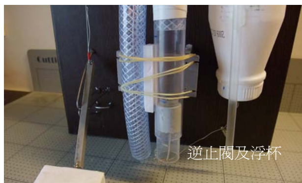
圖 5.4-2 潮汐發電自動虹吸管裝置照片
