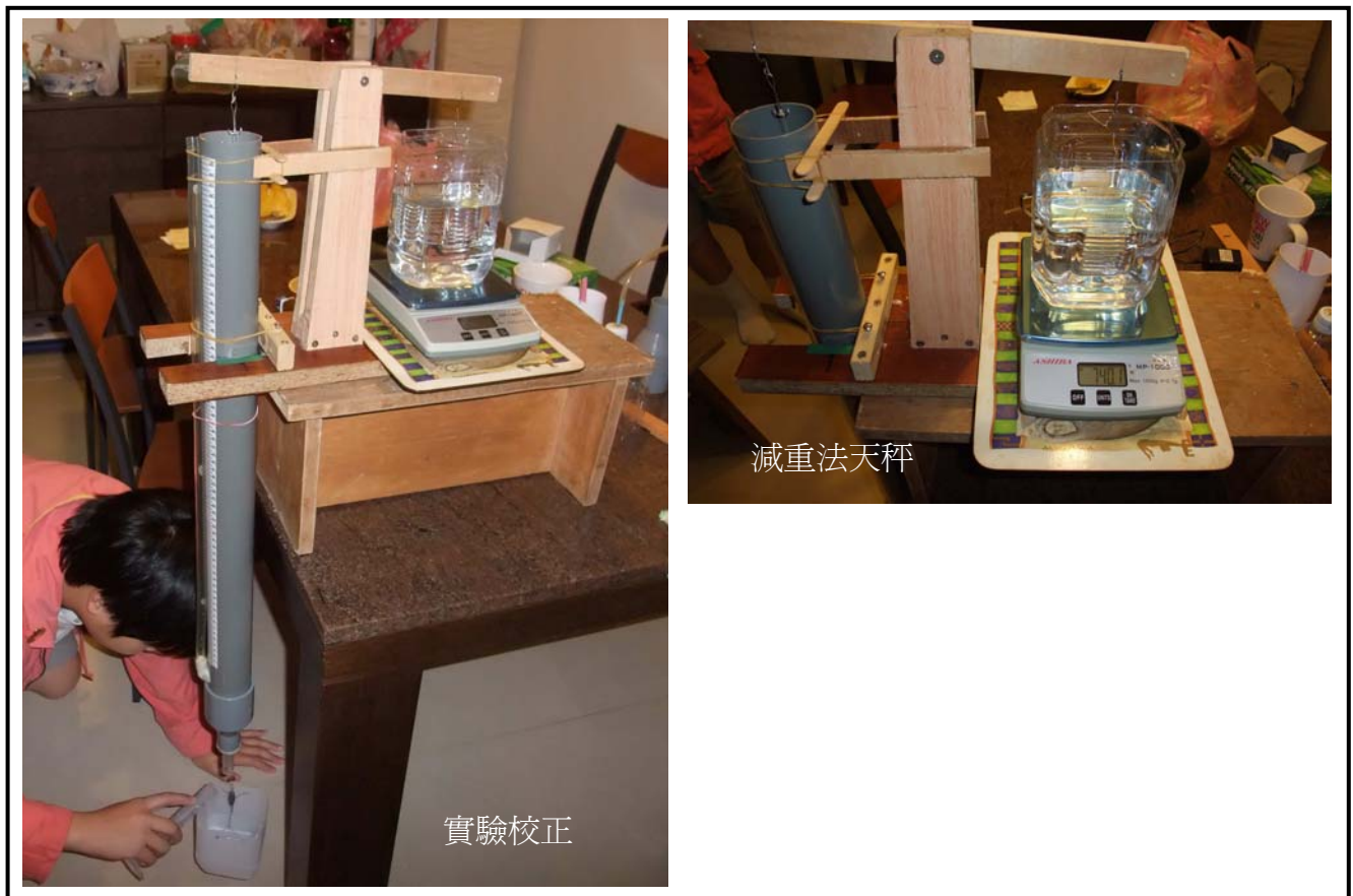
圖 4.1-2 壓力測量實驗設備照片
