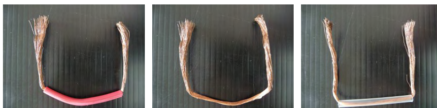
圖(四) 不同外面材質的銅絞線
