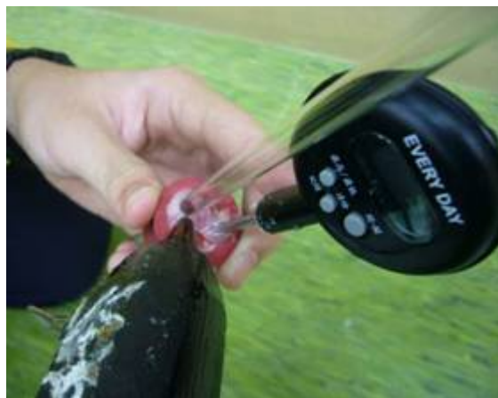
【圖 2】熱熔槍將玻璃管與電子溫度計完全封住
