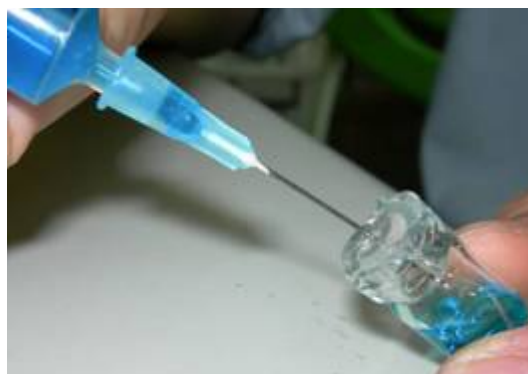
【圖 9】利用針筒直接在小玻璃瓶中 加入有色墨水溶液
