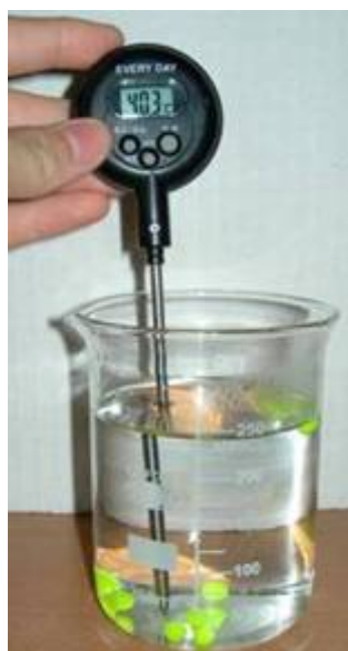
【圖 10b】溫度平衡後，再以鑷子夾出沉入 40°C 杯底小 B.B.彈
