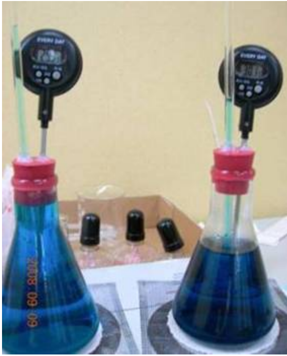
【圖 4】盡量避免空氣殘餘在錐形瓶中
