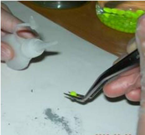
【圖 12a】 利用快速膠水將銅粉黏著於小 B.B.彈上
