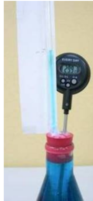
【圖 5】以雙面膠將硬紙卡緊貼住玻璃管
