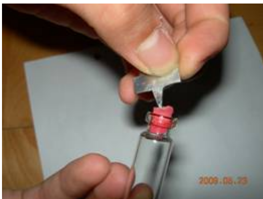
【圖 13f】將指示牌插入橡皮塞
