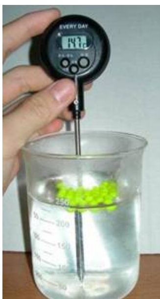
【圖 10a】可以浮在 15°C 蒸餾水或食鹽水上的小 B.B.彈
