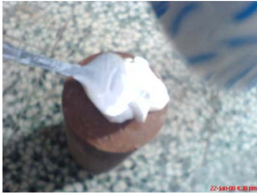
圖 5-26 將石膏塗抹在試體上並蓋平
