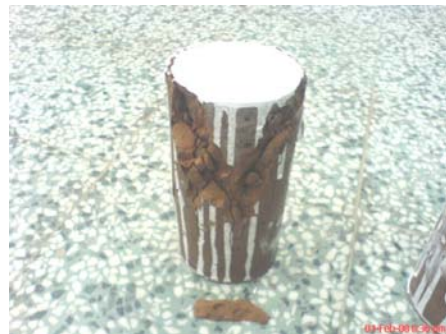
圖 5-29 試體抗壓後破裂情形
