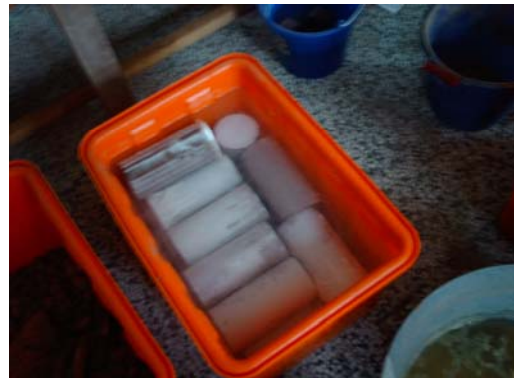
圖 5-25 將試體置入飽和石灰水溶液中養護
