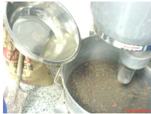
圖 5-21 加入總水量的 2/3 拌合強塑劑之溶液
