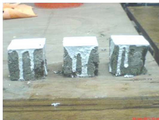
圖 5-39 抗壓後試體破裂情形(四)
