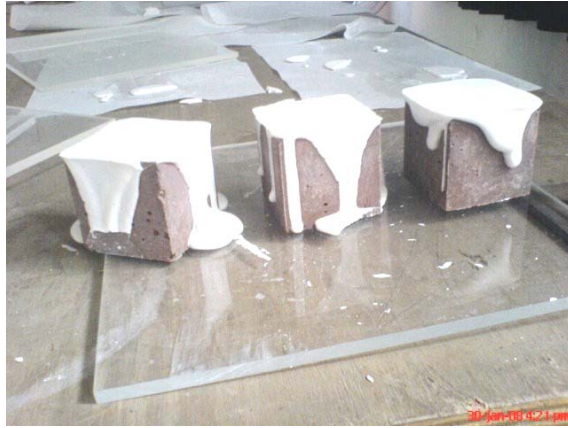
圖 5-33 將蓋平石膏置於試體上並蓋平
