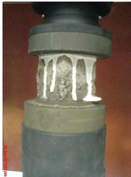
圖 5-34 方形試體置入抗壓機中進行抗壓 圖 5-35 方形試體置入抗壓機中進行抗壓
