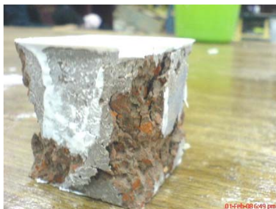
圖 5-38 抗壓後試體破裂情形(三)
