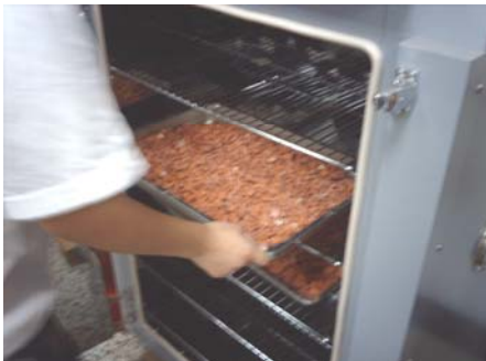
圖 5-12 取出已烘乾的紅磚粗粒料
