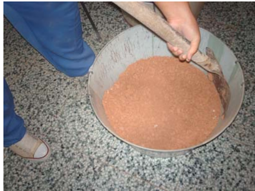
圖 5-15 將粗粒料與細粒料均勻拌合
