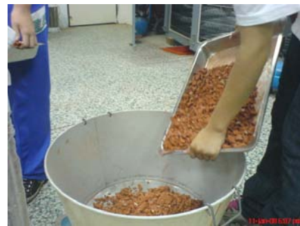
圖 5-13 集中已烘乾的紅磚粗粒料
