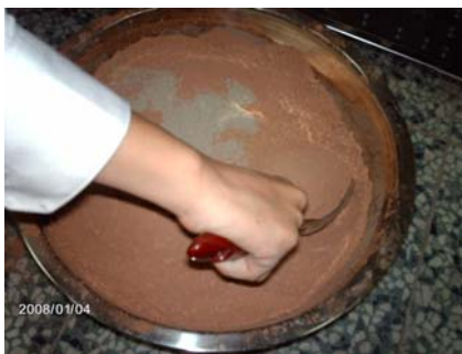
圖 5-9 將紅磚細粒料與飛灰均勻拌合
