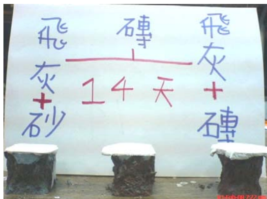
圖 5-36 抗壓後試體破裂情形(一)
