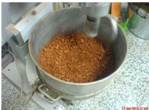
圖 5-18 將粗細粒料拌勻
