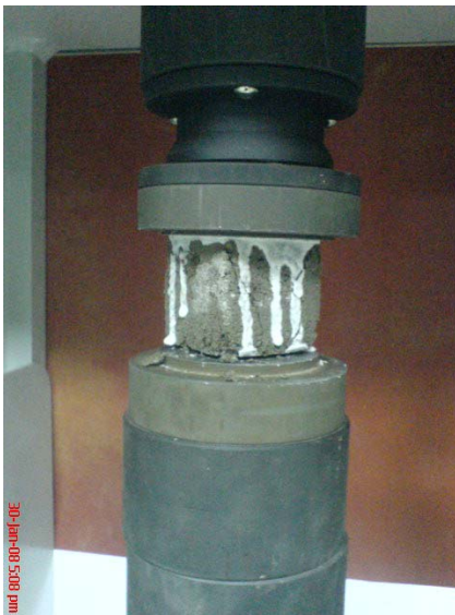
圖 5-34 方形試體置入抗壓機中進行抗壓 圖 5-35 方形試體置入抗壓機中進行抗壓
