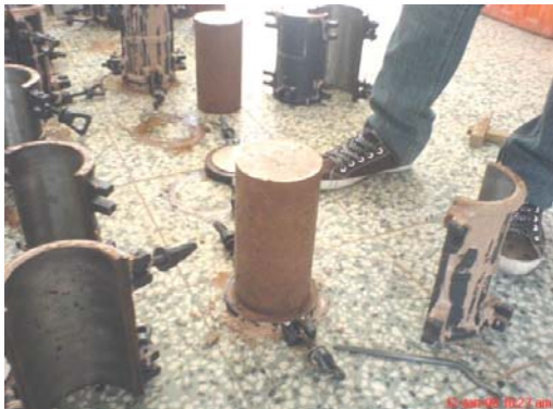
圖 5-22 拆開圓形試體模
