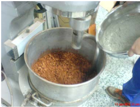
圖 5-20 將水泥倒入攪拌機中拌勻
