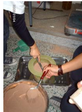
圖 5-10 將紅磚細粒料拌飛灰填入單位重量桶
