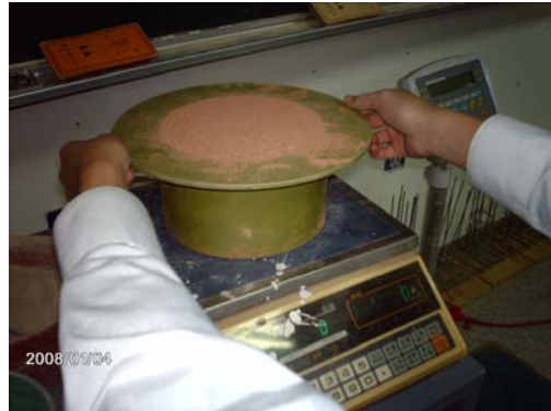
圖 5-11 將裝滿紅磚細粒料拌飛灰的單位重量桶置於電子秤上量取數據
