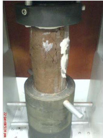
圖 5-27 置試體於抗壓機進行抗壓試驗
