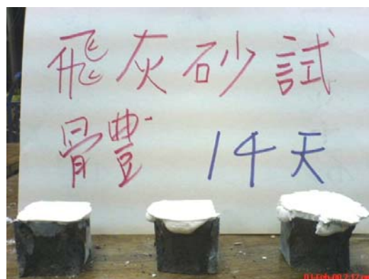
圖 5-37 抗壓後試體破裂情形(二)
