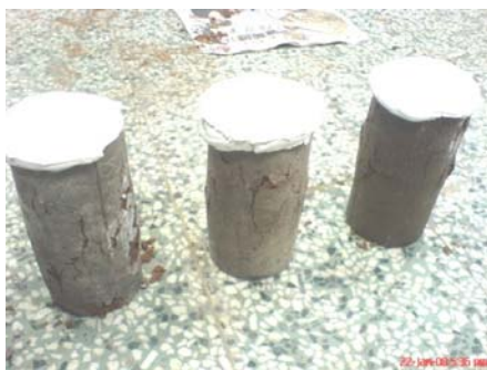
圖 5-28 試體抗壓後破裂情形
