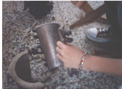
圖 5-23 清理圓形試體模並上油以防氧化
