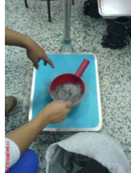
圖 5-8 量秤所需飛灰
