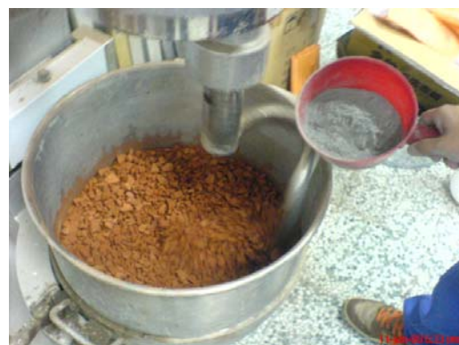
圖 5-19 將飛灰倒入攪拌機中拌勻
