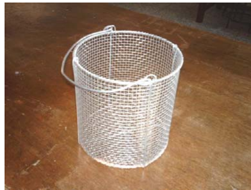
圖 4-7 比重試驗鐵絲網
