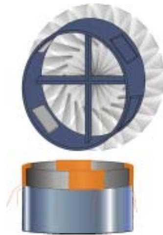
圖 10 垂直轉軸圓周繞線圈實驗試體示意
