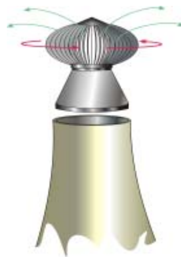
工廠排煙(蒸汽)管加設中型發電機
