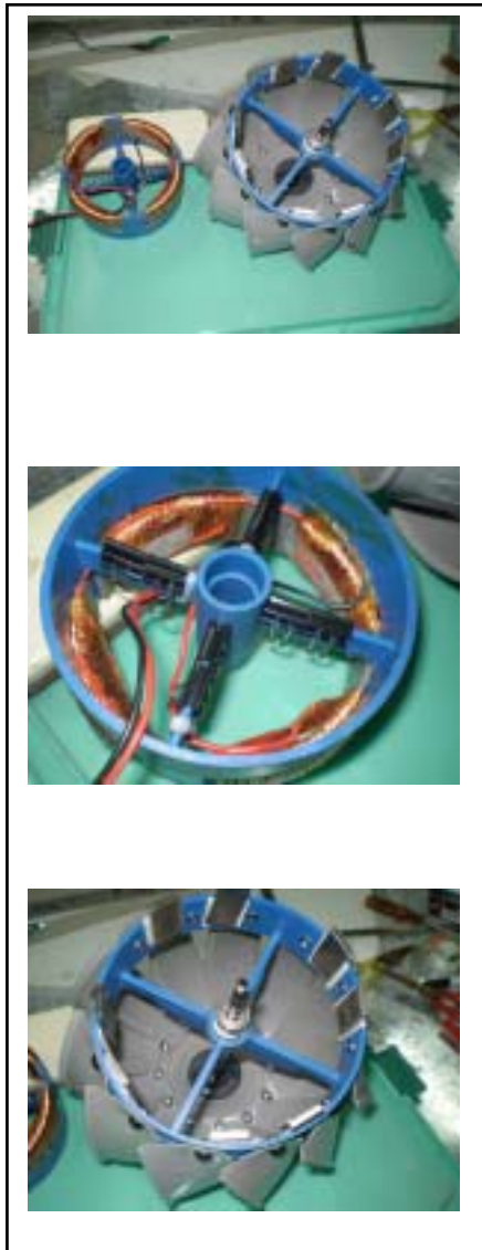
圖 24 四組線圈 2000 匝 4@90° 八塊磁鐵八個 19mm 長 尾夾試體
