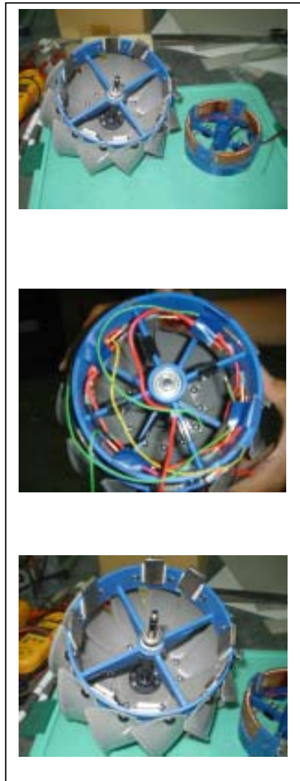
圖 23 四組線圈 600 匝 4@90° 八塊磁鐵四個 19mm 長 尾夾試體
