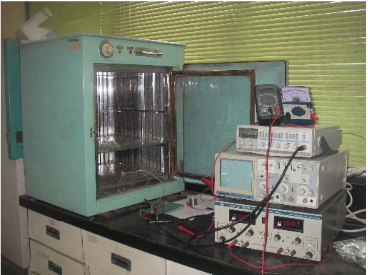
圖 21. 溫度特性實驗系統（左側為恆溫箱）
