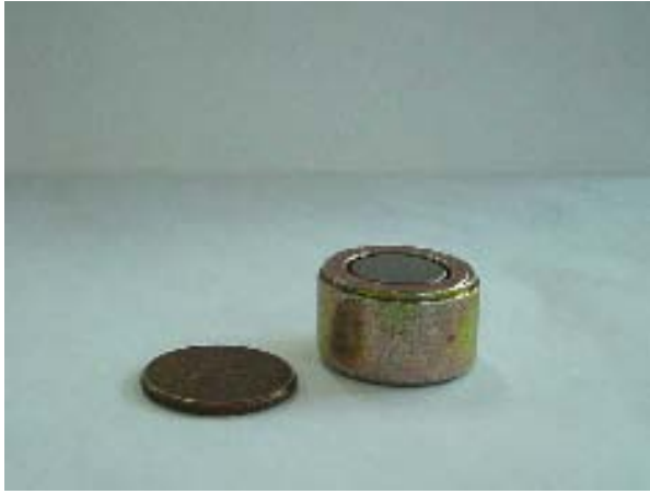
圖 3. 感測器之強力磁鐵，空隙內為磁場
