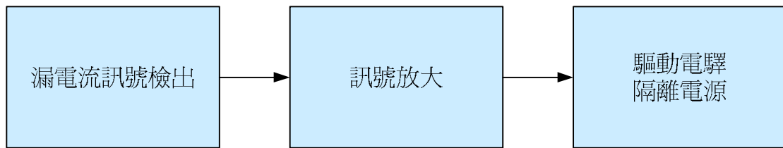
圖(19)漏電保護三階段
