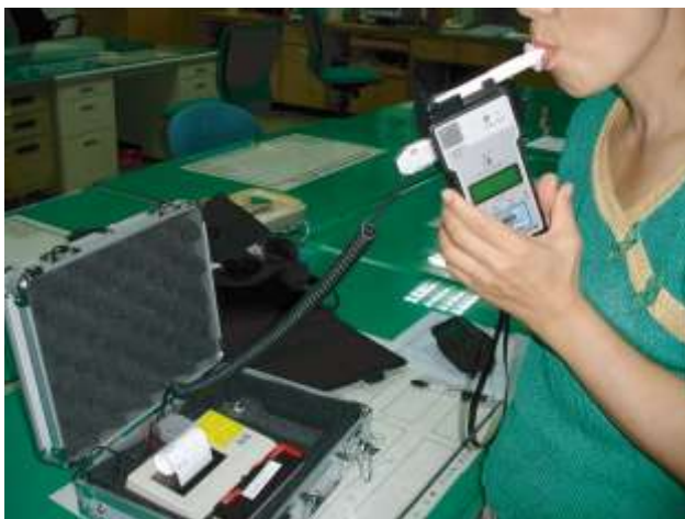
圖(十三) 用警用酒測器校正酒精感測器(一)
