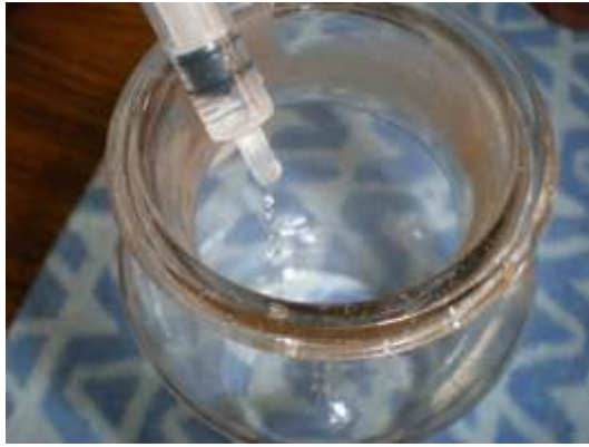
圖(三)將酒精滴入試驗瓶中
