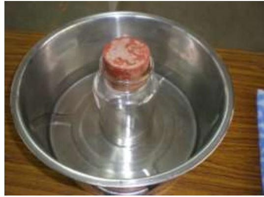
圖(四)將試驗瓶浸泡在熱水中
