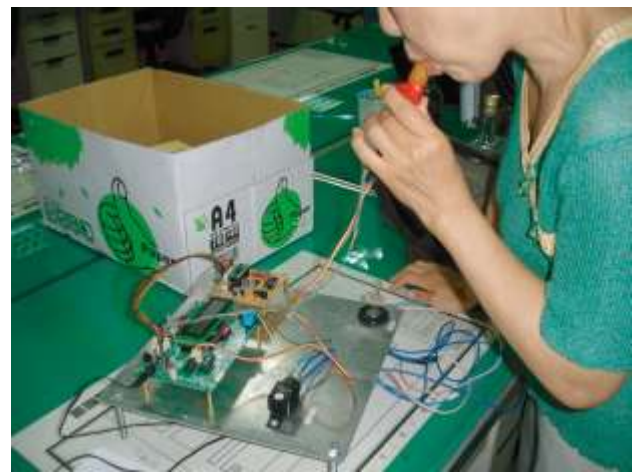
圖(十三) 用自製酒測器校正酒精感測器(二)
