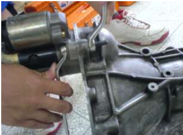
圖(十一) 變速箱與起動馬達結合過程
