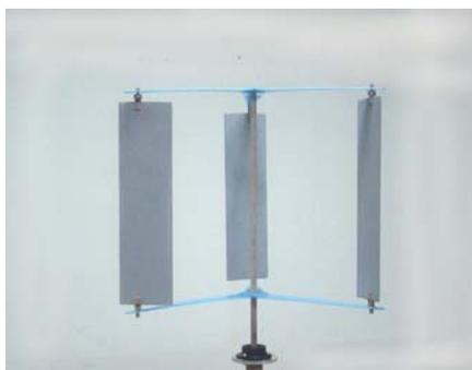
圖 2-4 第二型垂直軸風車
