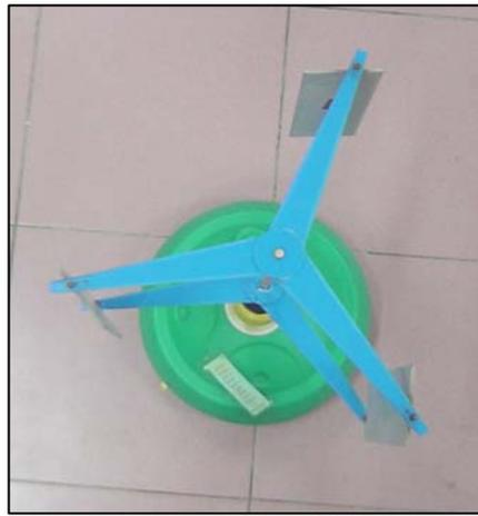
圖 2-5 第二型垂直軸風車俯視圖
