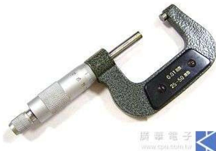
分厘卡 (Micrometer) 又稱為測微器或千分尺，是常用的測量儀器。一般分厘卡測量精度為 0.01mm，若附加游標可達到精度為 0.001mm。其測量原理是利用螺紋的迴轉角度和直徑，把長度的變化量放大，並將此放大長度製成刻度，故利用分厘卡就可讀取微小長度的變化量，通常標準型精度為 0.01mm，分厘卡的心軸螺紋節距是 0.5mm，並把套管分 50 等份，因此每轉套管 1 刻度，心軸移動 0.01mm。
