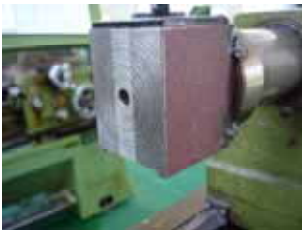
圖 4-7 磁力定位座套於尾座心軸上
