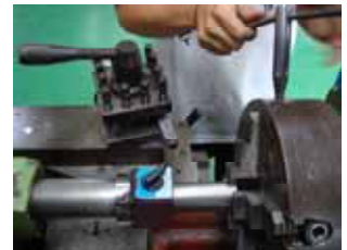
圖 4-10 移動夾爪以夾持工件
