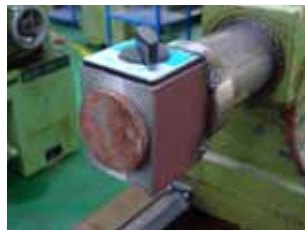
圖 4-8 將工件吸附於磁力定位座上
