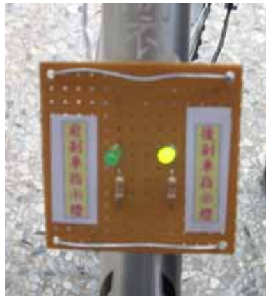
圖 5-8 後剎車已作用
