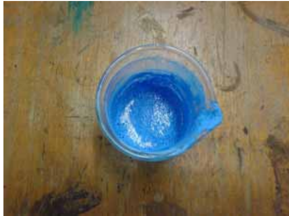
圖八：混合塗布（甲基藍+塗料）
