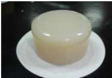
圖一、寒天凍經 2.5 小時仍無法完全潤濕濾紙，濾紙表面已風乾僅留下水痕。
