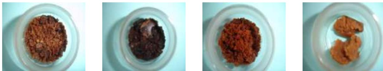
圖六、膠質添加物(由左而右依序為寒天、洋菜、蚶蕨、愛玉)水解後，濾液加熱蒸發後產生之結晶物。
