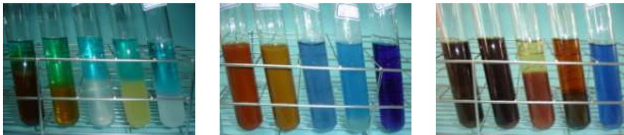
圖五、膠質添加物(由左而右依序為寒天、洋菜、蚶蕨、愛玉和明膠)水解後加入斐林試劑(左圖)、搖勻後(中圖)、加熱後(右圖)。
