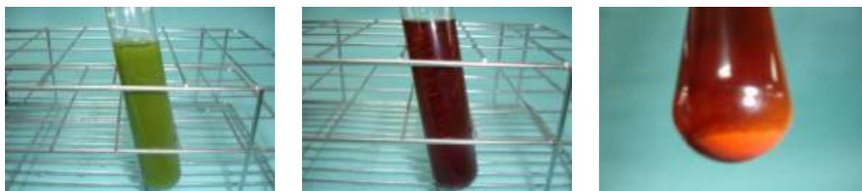
圖七、市售寒天茶水解後加入斐林試劑(左圖)、加熱後(中圖)、靜置後產生之磚紅色沉澱(右圖)。
