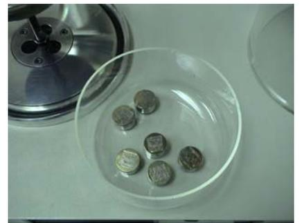
圖 20、進行掃描式電顯前需以金箔電鍍
