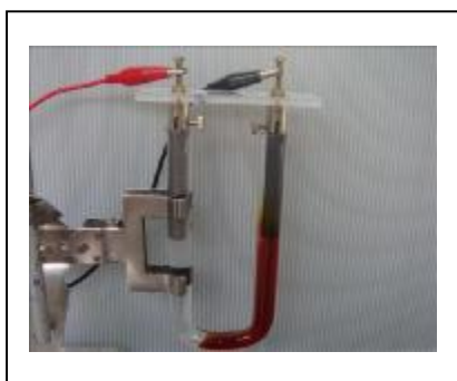
圖 17-5：電解一段時間後， I_3^- 產量增加，因此顏色加深
