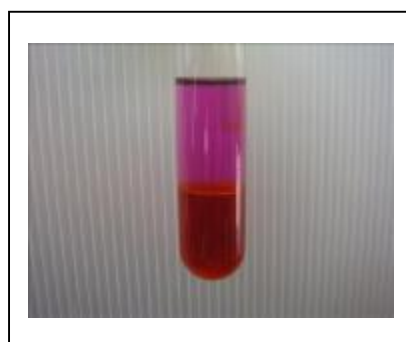
圖 19-2：深褐色的正極溶液加入正己烷，搖晃後則分為兩層，上層為 I_2 溶於正己烷中，呈紫色；下層為 I_2 溶於 KI_{(aq)} 中，呈褐色。
