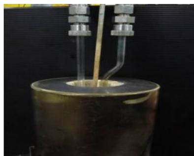
圖 5-3 置入溫度計及石英管之管狀爐
