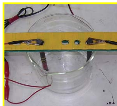
圖 13 裝置上的洞可以調整電極距離。
