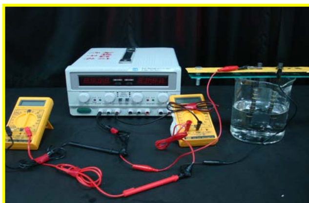
圖 3 測量導電度之裝置
