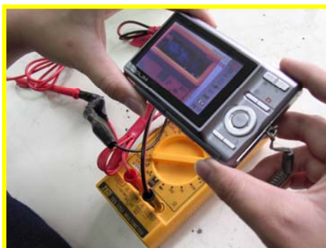
圖 11 用數位相機紀錄電流的變化
