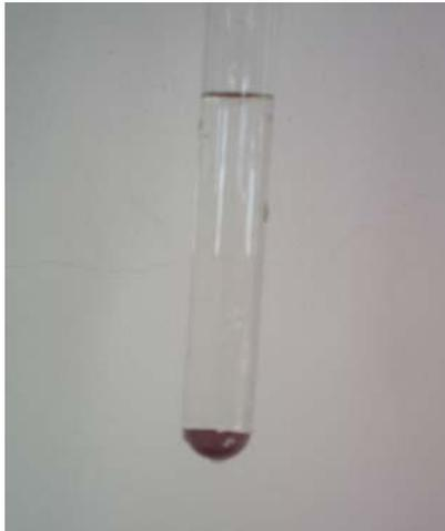
為了確定奈米磁性顆粒是否只因磁性而加速沉降，我們拿了同樣有磁性但顆粒較大的鐵粉做相同的實驗。因鐵粉顆粒太大又太重，無法溶於水中而直接沉在水底，也因此無法被明礬包覆。
