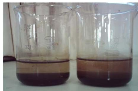
NH<sub>3</sub>在沉降至8ml高度時的時間與NaOH的時間差不多，而之後速率慢下來，我們在製作磁性顆粒時觀察到用NH<sub>3</sub>製作的奈米磁性顆粒和用NaOH製作的奈米磁性顆粒比起來沉澱凝聚性較強，因此我們推測用NH<sub>3</sub>製作的奈米磁性顆粒受重力影響較大。
