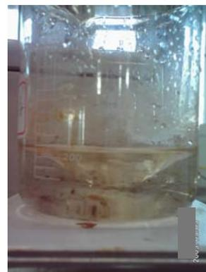
3. 用環狀磁鐵置於下並靜置 30min, 等溶液出現明顯分層時以滴管移除濾液 100ml，再加入蒸餾水 100ml。重複此步驟以  $\text{H}_2\text{O}$  洗 1-3 次，最後再配 0.01M HCl 100ml 洗 1 次。HCl 用以中和鐵離子上的負電荷。
