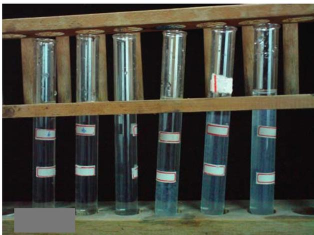
溶液在沒有氫氧化鈉(試管 1)、氫氧化鈉很少量(試管 2、3)時呈透明澄清，試管 4、5、6 成白色混濁。而其中試管 4 沉降速率最快，故以試管 4(2ml)為最佳濃度。
