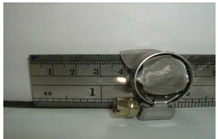
圖（1-4）：濾網 4（單位面積 250 孔）
