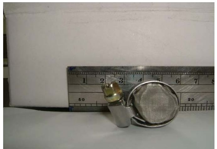
圖（1-2）：濾網 2（單位面積 120 孔）
