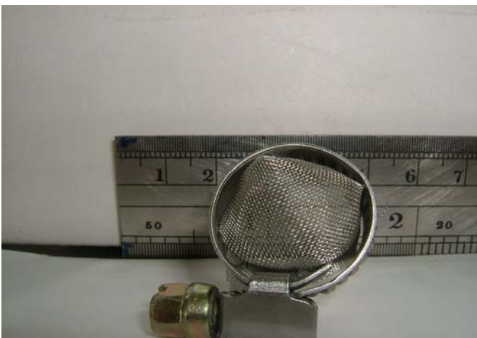
圖（1-1）：濾網 1（單位面積 60 孔）
