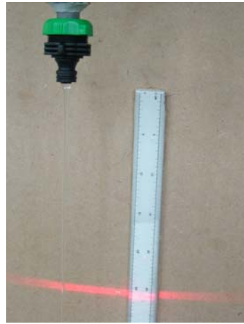
圖 (1-5)：右圖雷射光明顯被水柱散色，定義為水柱斷點
