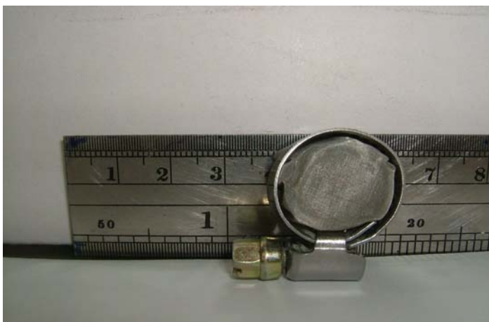
圖（1-3）：濾網 3（單位面積 200 孔）
