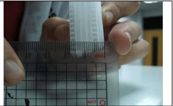
照片5 - 六片塑膠瓦楞板總厚度 1.8cm
