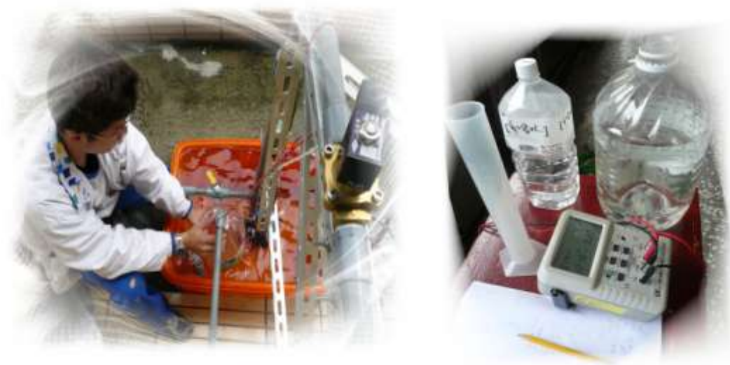
圖九 量測飲水機廢水率及消耗功率值
