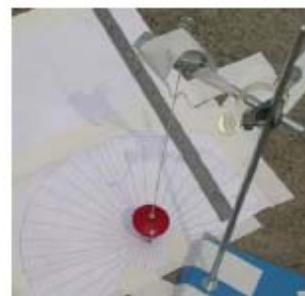
5. 作法五：沿用作法四的方法，在鉛錘下方放置圓形方位紀錄紙，先在紙上點出各時刻的影子頂點，一整天觀測結束後再畫線〈線長與影長垂直，連接鉛錘線頂點與影子頂點〉，測量高度角。
