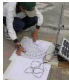
3. 作法三：以砝碼和繩子製作鉛垂線，替代竿子並記錄影子的位置變化，並用量角器立刻拉線測量太陽高度角
