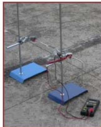
階段二：選用【大太陽能板】做實驗，測量同一時間，相同方位，不同太陽能板傾斜角度對太陽能板電功率的影響：
