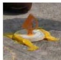
2. 作法二：回歸原始測量方式，以架子紀錄竿影位置和長度變化，盡量多蒐集一些數據。
