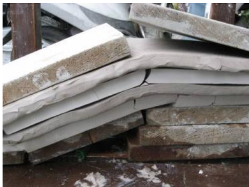
圖 84、軟陶板產生背斜，硬陶板沿著背斜軸斷裂。
