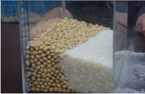
圖 79、推擠 15 公分後黃豆和白米交界處的傾斜角由 90^\circ 改變成 78^\circ
