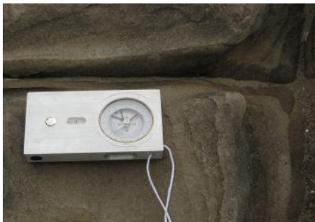
圖 33、練習使用傾斜儀測量岩層的走向。
