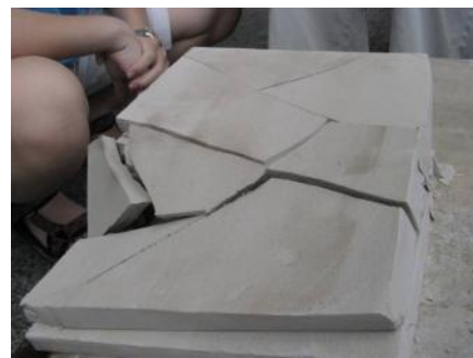
圖 83、硬陶板形成好幾組交錯的斷層線，越接近震源破裂越嚴重。
