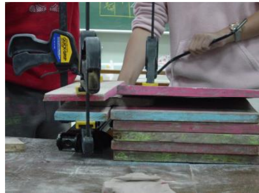
圖 5、使用千斤頂和木工夾做逆斷層模擬實驗
