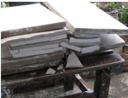
圖 82、當水球破裂的瞬間，從側面可以清楚的看到硬陶板斷裂，而軟陶板褶曲的現象。
