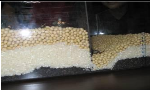
圖 60、由右向左推五公分後，模擬岩層傾斜角度的測量數據如下：
