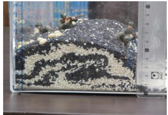
圖 2、沙箱斷層模擬實驗，可以從剖面中看見斷層形成的過程，並了解斷層錯動對地表的影響。
