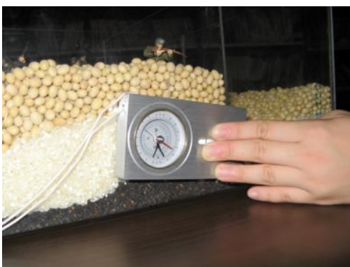
圖 6、實驗時用傾斜儀測量斷層傾角
