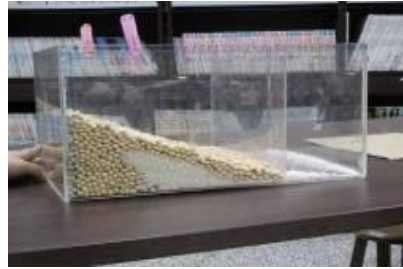
圖 81、放手後，壓力釋放，黃豆層迅速埋沒白米，白米形成逆斷層。
